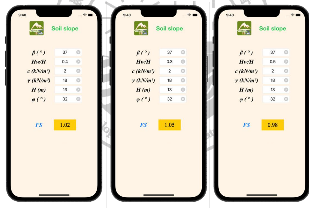
圖(2-45) 集集鐵路隧道崩塌地 App 工具計算安全係數之結果
