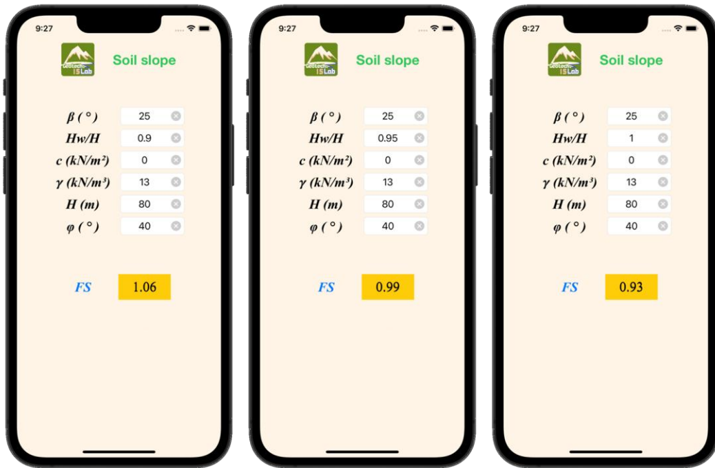
圖(2-44) 黃竹里崩塌地 App 工具計算安全係數之結果
