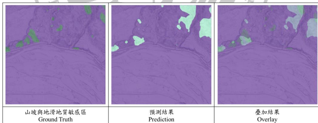
圖(2-52) 集集鐵路隧道崩塌地 AI 模型預測
