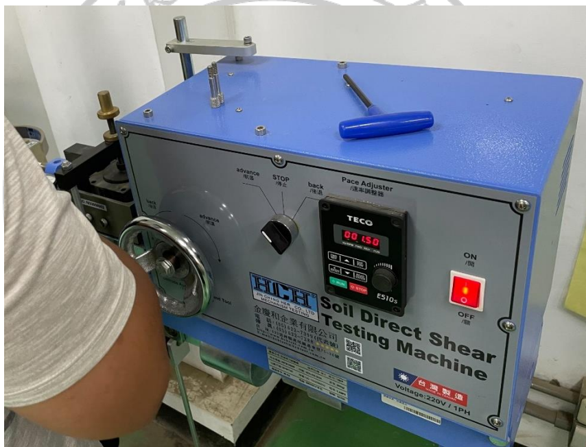
圖(2-22) 剪動速率為 1.5mm/min
