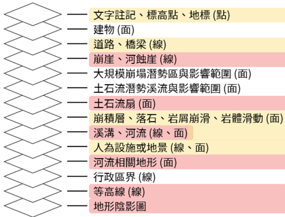
圖 3-2 地形特徵圖主圖圖層之引用、編修與自行產製圖層說明
