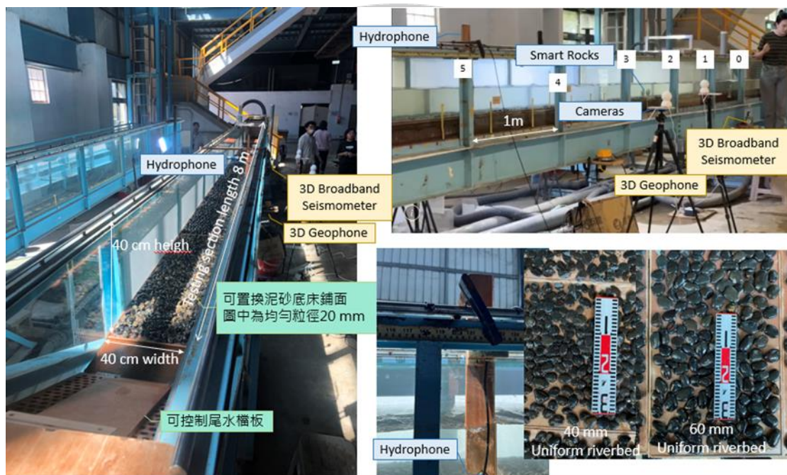
圖 10 室內渠槽試驗規劃及配置圖
