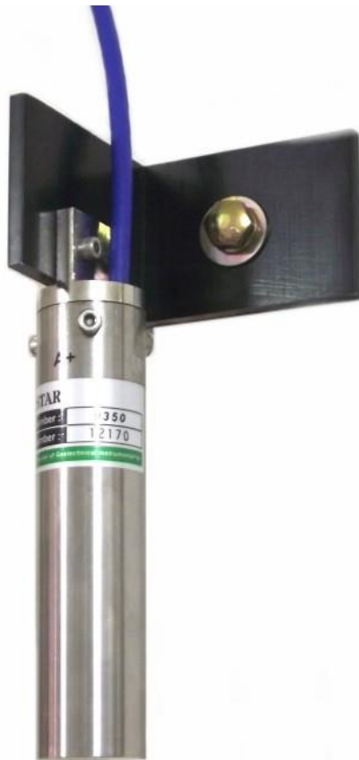
圖 3-5 雙軸傾斜儀照片與規格
