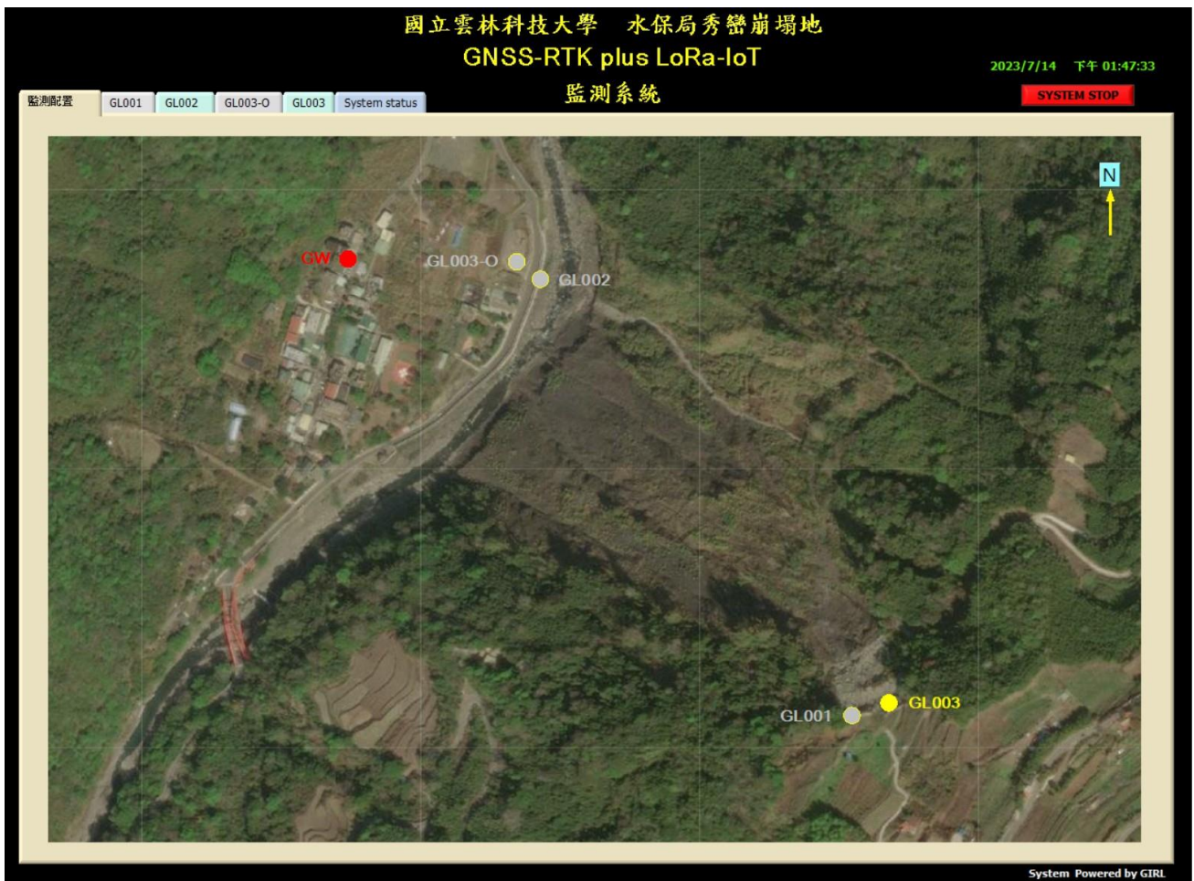
圖 4-10 新竹縣尖石鄉秀巒村 LoRa-GNSS 與 GNSS-RTK 傳輸測站位置
