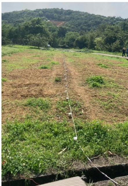
圖 三-7 地電阻佈線過程(1)
