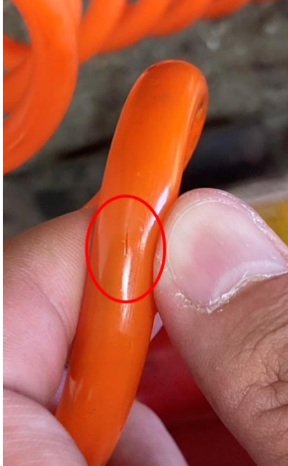
圖 三-40 氣管龜裂(紅圈內)
