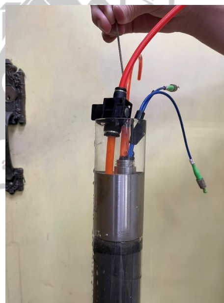
圖 三-4 封塞器壓力測試過程(1) 圖 三-5 封塞器壓力測試過程(2)
