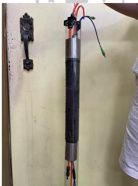
圖 三-4 封塞器壓力測試過程(1) 圖 三-5 封塞器壓力測試過程(2)
