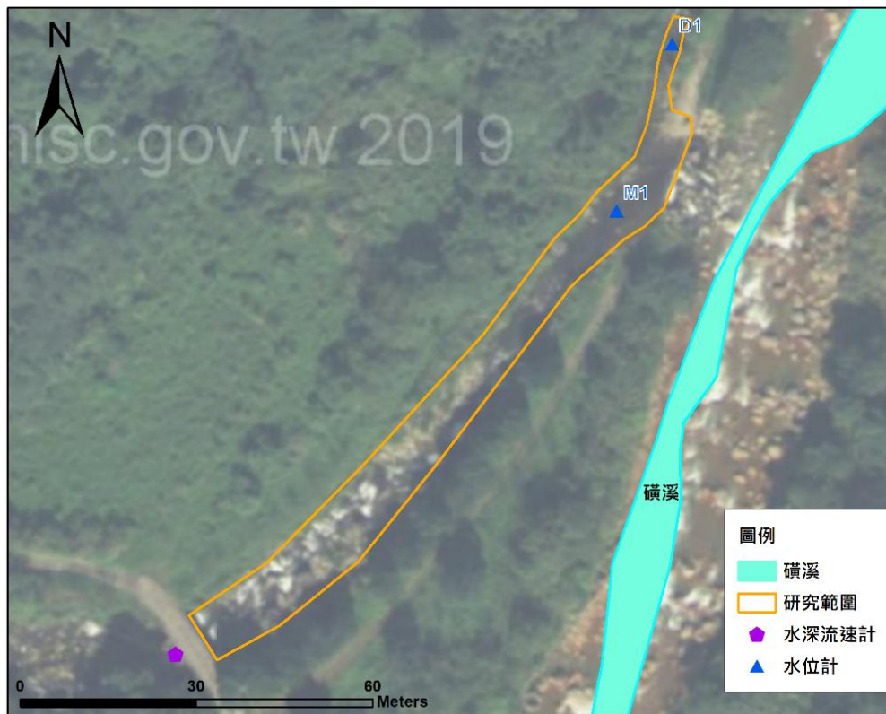
圖 2-16 水深流速計及水位計安裝位置圖
