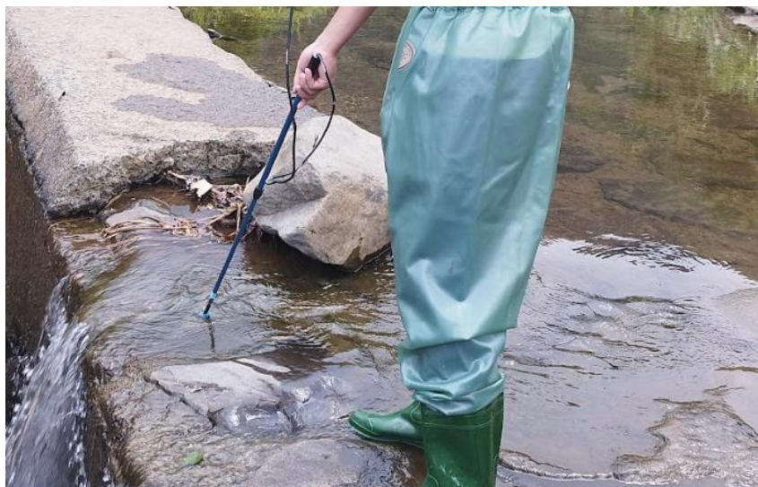
圖 2-14 手持式流速儀量測河川斷面流速與水深量測現地照片
