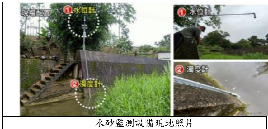
圖 5-1 善東橋下游取水堰架設水砂監測設備示意圖
