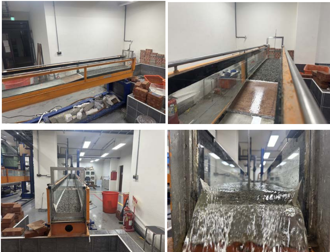
圖 4.3 渠槽試驗布置
