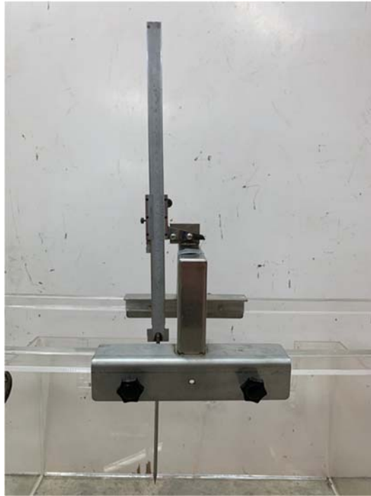
圖 4.6 探針式水位量測裝置
