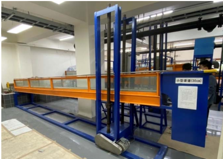
圖 4.1 室內可變坡度渠槽
