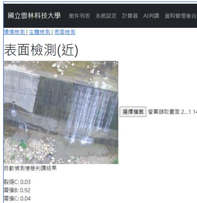
圖 4-32 案例一 構造物表面現況辨識結果
