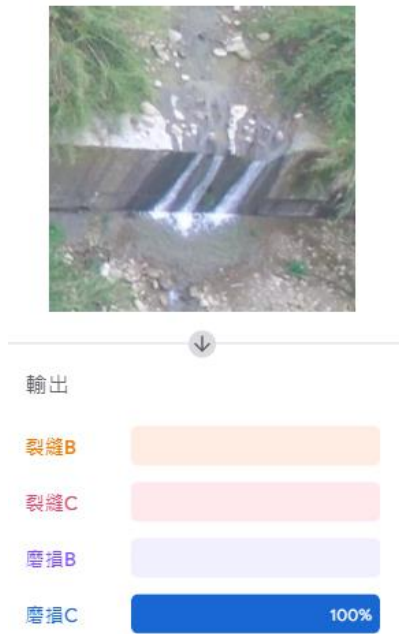
圖 4-29 構造物表面現況影像辨識結果
