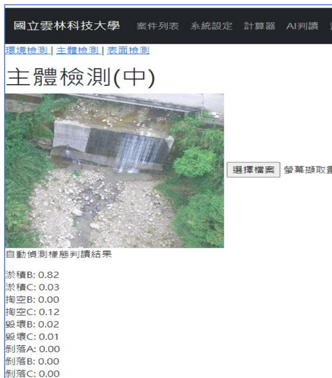
圖 4-31 案例一 構造物現況分析辨識結果
