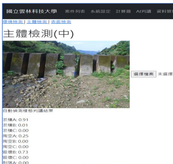
圖 4-35 案例二 構造物現況分析辨識結果
