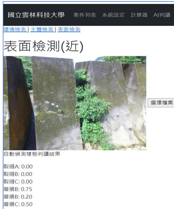
圖 4-36 案例二 構造物表面現況辨識結果
