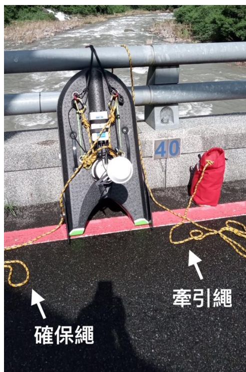
圖 5-10 於高速流況時可於 ADCP 繫上牽引繩及確保繩
