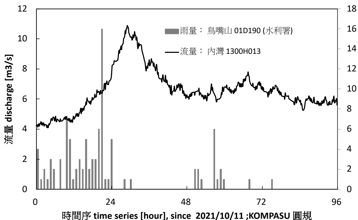
圖 4-47 頭前溪支流油羅溪內灣站颱風事件降雨與流量歷線：事件編號 N16
