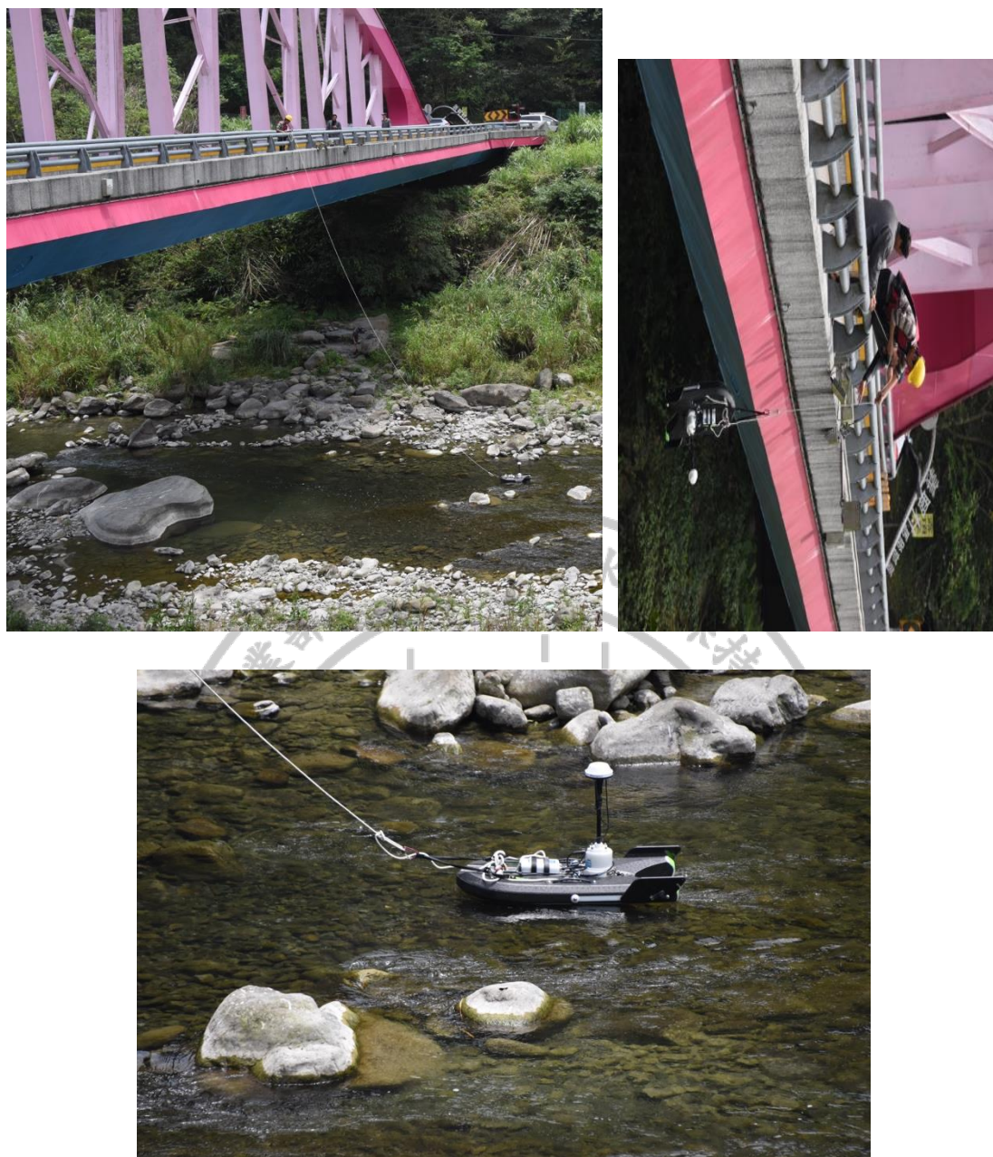
圖 5-9 聲波都普勒流速剖面儀現場操作情況 (以內灣站為例)
