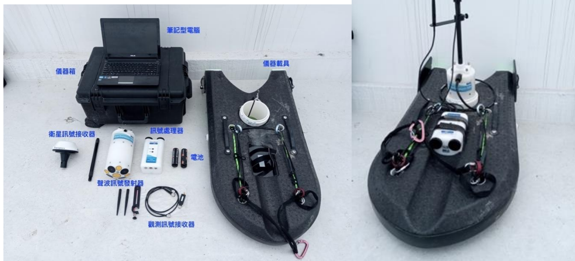
圖 4-12 聲波都卜勒流速剖面儀 ADCP；SonTek RiverSurveyor M9 系統
