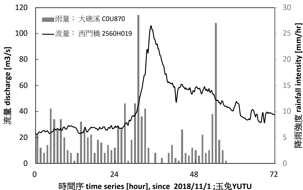
圖 4-31 宜蘭河西門橋站颱風事件降雨與流量歷線：事件編號 X9
