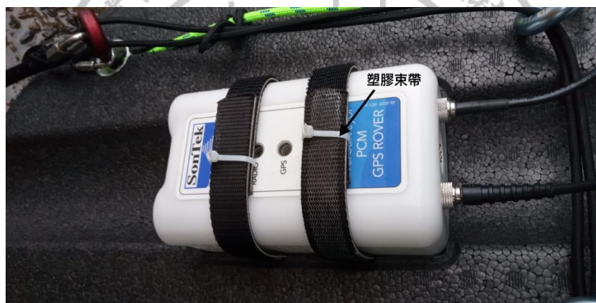
圖 5-11 以塑膠束帶加強固定 PCM
