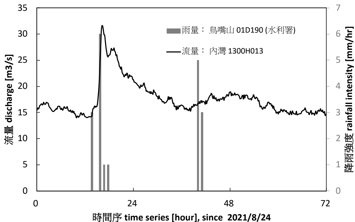
圖 4-45 頭前溪支流油羅溪內灣站颱風事件降雨與流量歷線：事件編號 N14
