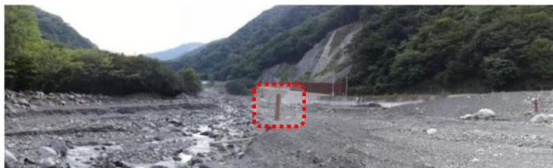
參考圖 5.1.4 春木川設置砂面計周邊河床材料之變化
