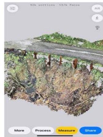
LIDAR掃描測繪法
