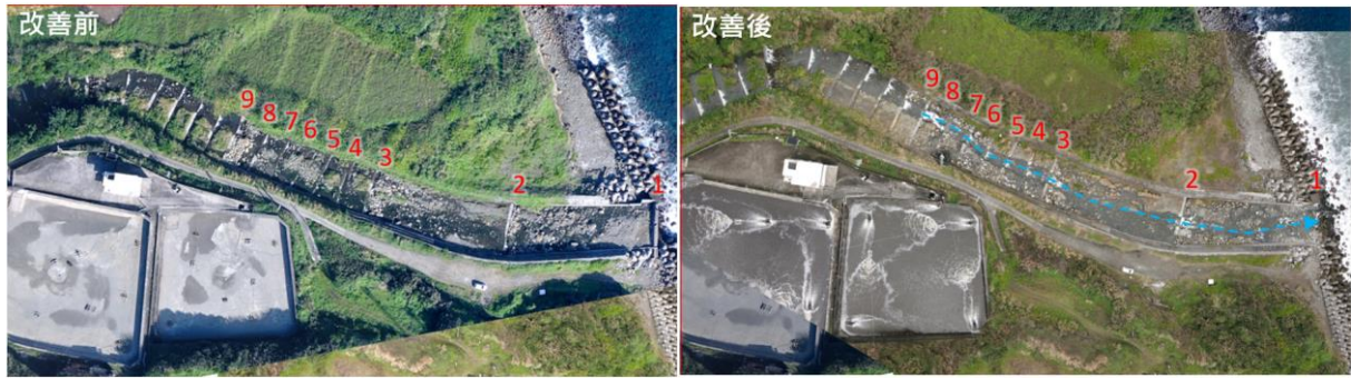
圖3-2 大不岸溪下游固床工改善試驗前後空拍對照
