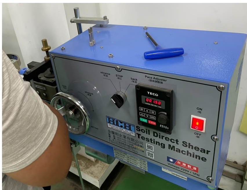
圖(2-21) 剪動速率為 1.5mm/min
