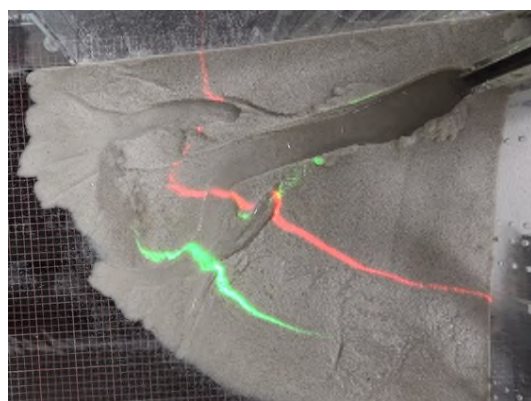
圖 4-4 滲流破壞，10°扇面， Q=20 \text{ cm}^3/\text{s} ， t=480\text{s} ，乾粗砂沖積扇
