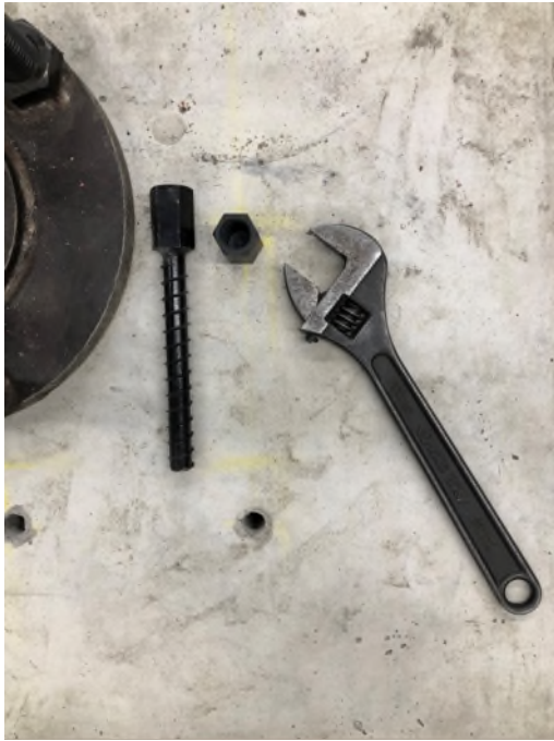
圖 4-32 新型#5 螺紋植筋錨栓成品與試驗後照片
