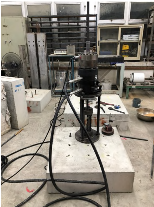
圖 4-33 新型#5 螺紋植筋錨栓試驗組裝照片
