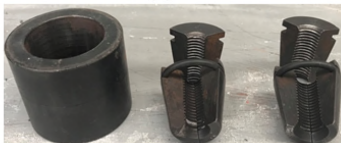
圖 4-3 化學錨栓圍束抗張試驗設備
