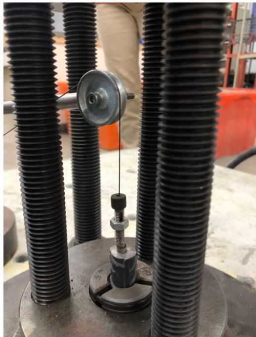
圖 4-33 新型#5 螺紋植筋錨栓試驗組裝照片
