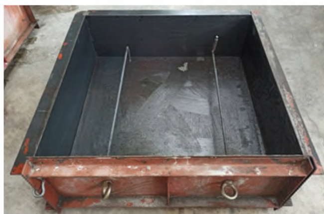
圖 4-4 無開裂混凝土試驗構件示意圖與灌製模具
