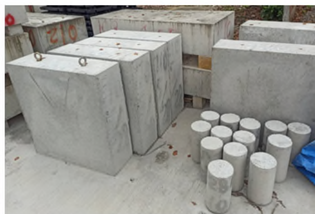
圖 4-4 無開裂混凝土試驗構件示意圖與灌製模具
