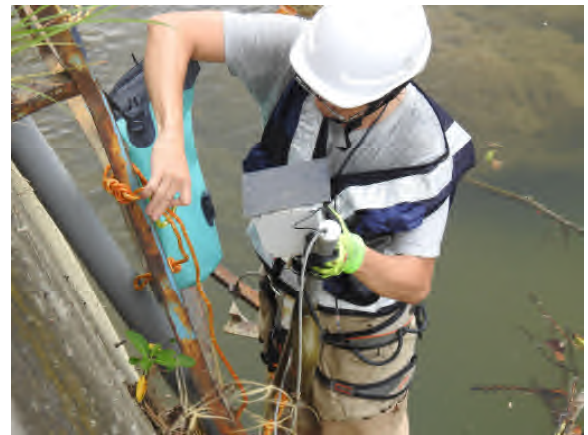
圖 37、回收水盒子進行機體及感測器檢查
