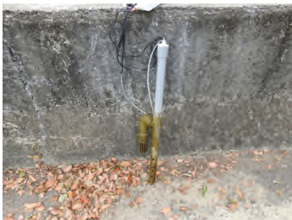
圖 38、感測器外殼已明顯有一層生物膜
