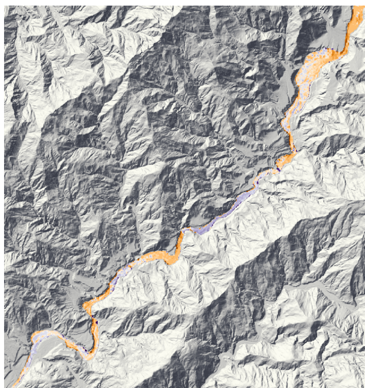
(a) 2018 年汛期前後河道侵淤變化
