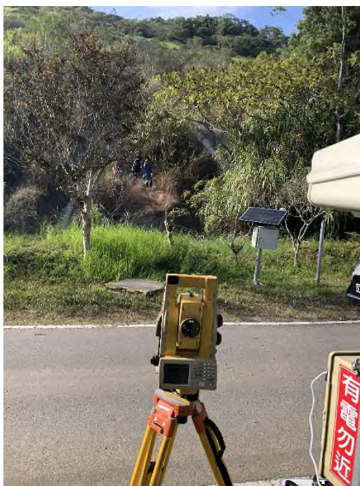
圖 2-2-86 全測站雷射經緯儀之現地照片
