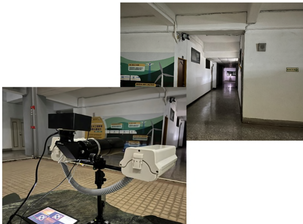
圖 2-2-25 變位儀率定試驗(B)
