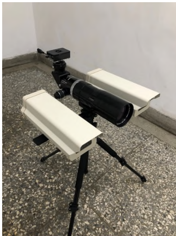
圖 2-2-84 三目電腦視覺式變位監測儀
