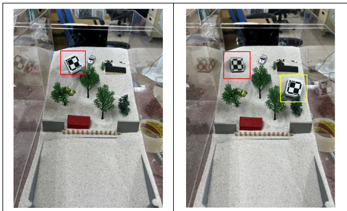
圖 2-2-6 砂箱實驗多點立體規標滾落示意圖
