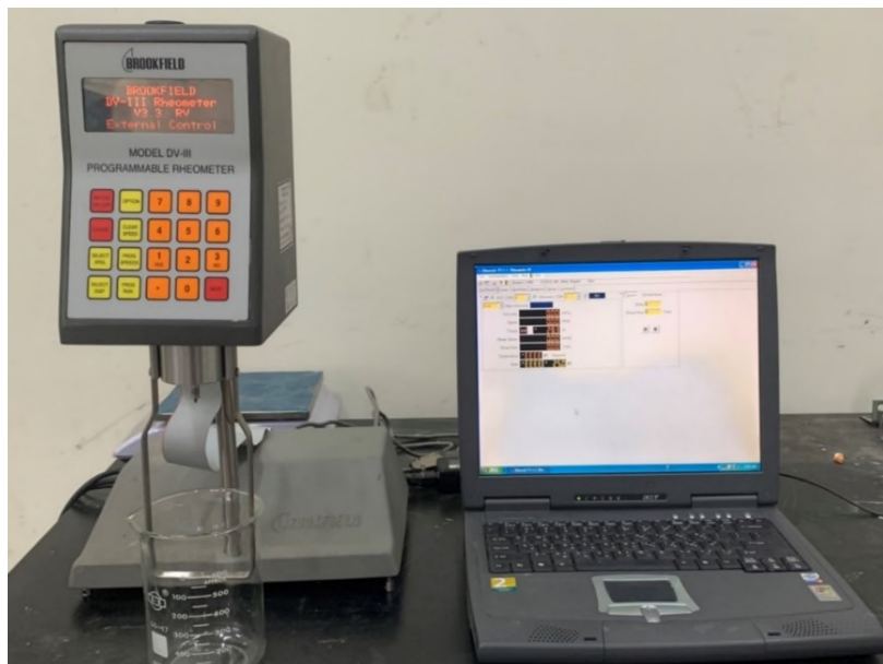
圖 3.5 DV-III 流變計及資料擷取系統之整體試驗配置圖
