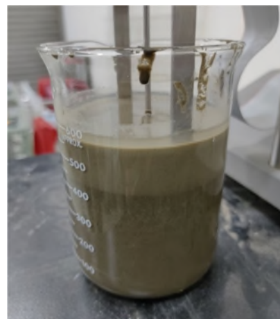
圖 3.13 體積濃度 37.5% 靜置後之現地沙漿分層現象
