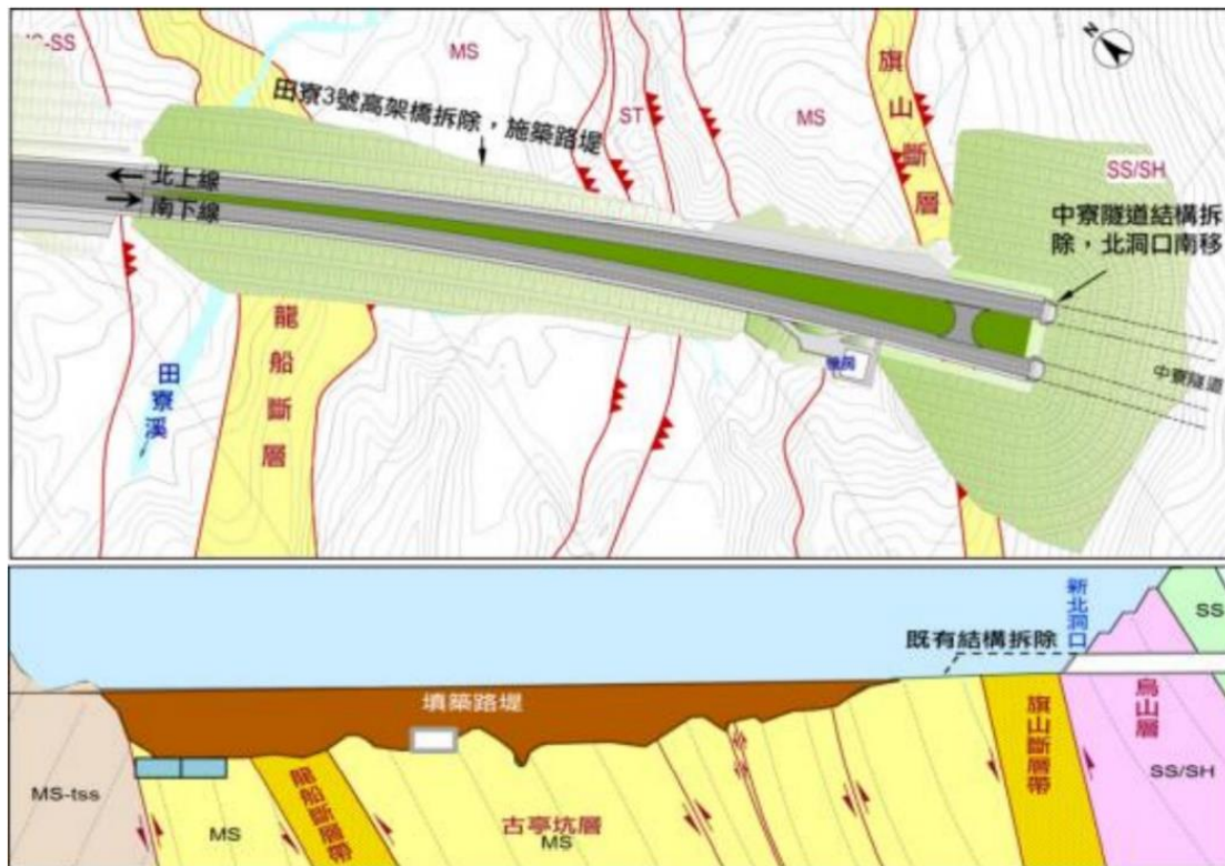
圖 2-15 長期改善工程配置示意圖(高公局，2018)
