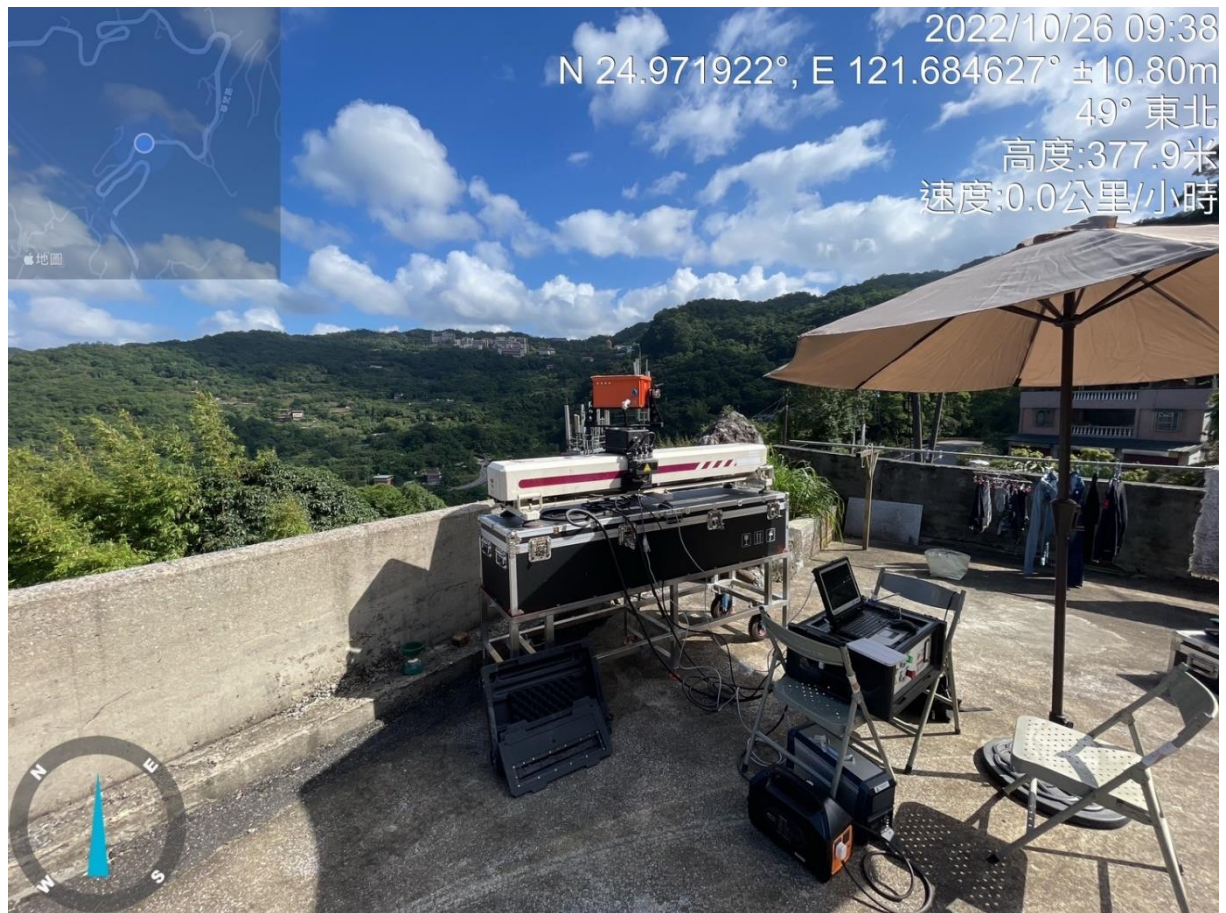
圖 3-41 GB-SAR 現場測試掃描 T001 崩塌地
