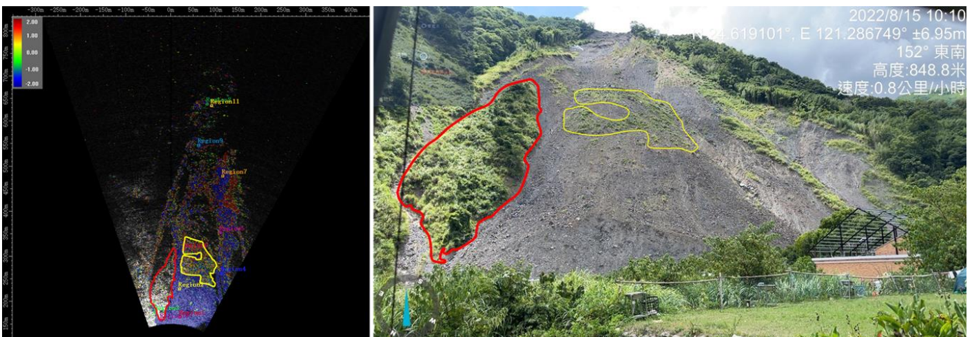
圖 3-15 2022 年 8 月秀巒監測工作之雷達影像(左)與現場目標對照(右)
