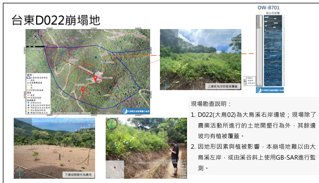
圖 3-39 台東大鳥 D022 現場評估 GB-SAR 設置情況
