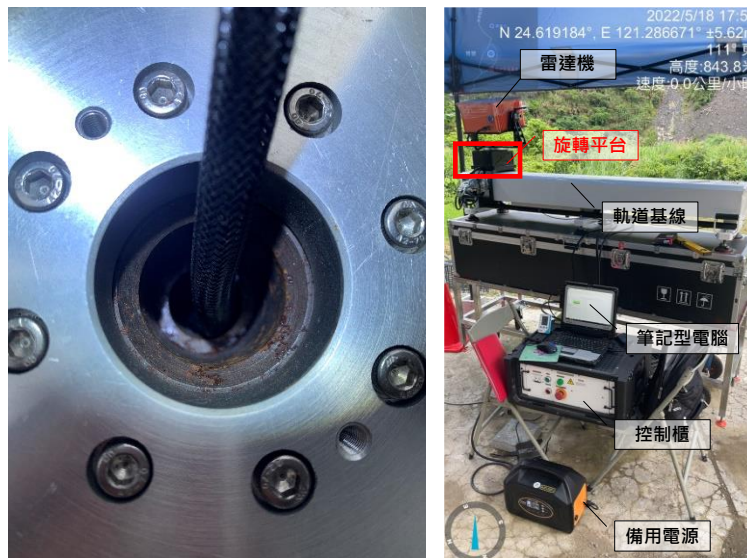
圖 3-11 GB-SAR 儀器冒煙位置(左)設備相對位置照片(右)
