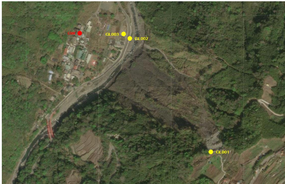
圖 4-3 新竹縣尖石鄉秀巒村 LoRa-GNSS 與 GNSS-RTK 傳輸測站位置
