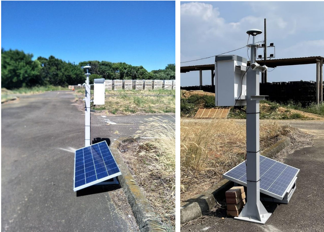
圖 3-9 LoRa-GNSS 與 GNSS-RTK Base 端設備現場照片(於明新科大)
