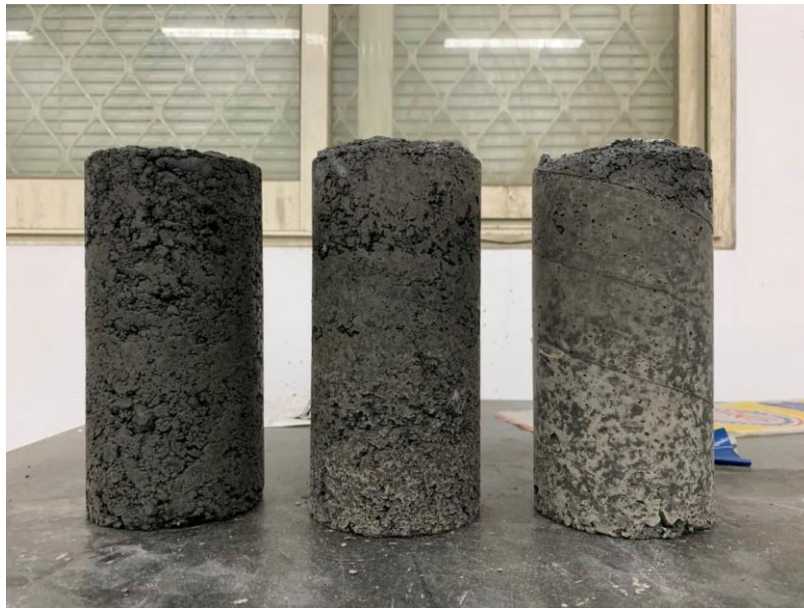
圖5-38 馬崙溪拌合試體 (左1:6，中1:9，右1:12)
