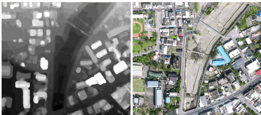
圖 4-7 航拍正射影像及 DSM 比較圖(右：正射，左：DSM)
