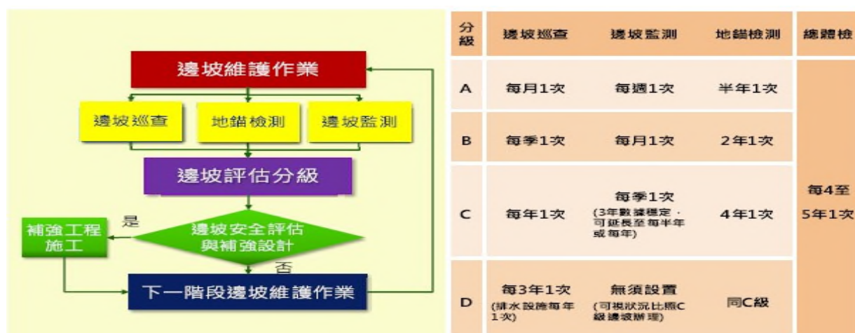
(a)邊坡維護作業流程
