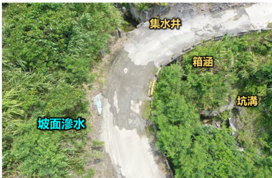
圖 4-13 坡面滲水病兆特徵示意圖
