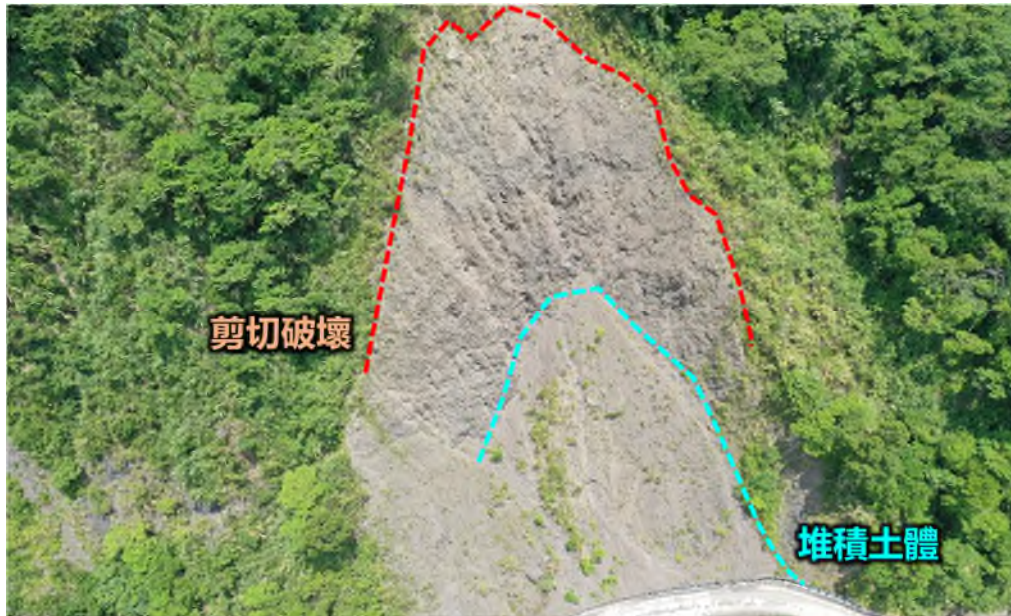
圖 4-16 坍塌、地滑病兆特徵示意圖
