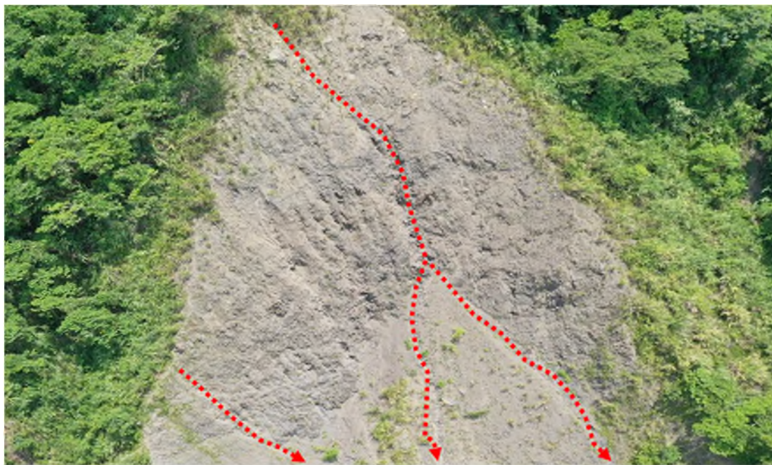
圖 4-11 坡面沖刷病兆特徵示意圖
