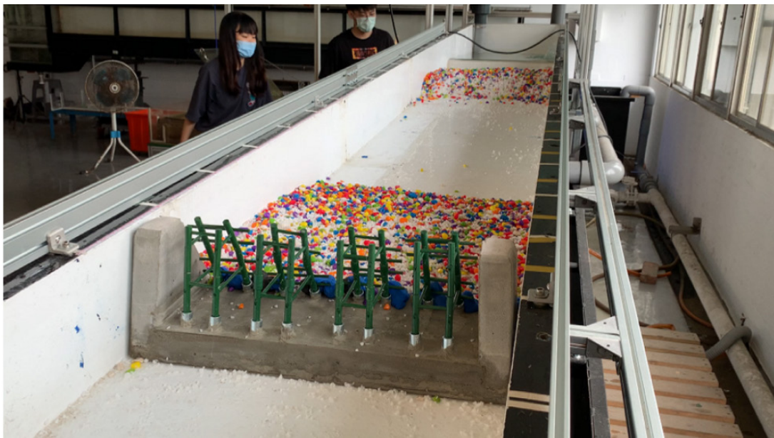
圖 2-10 河工動床教學試驗水槽與防砂壩配置。
