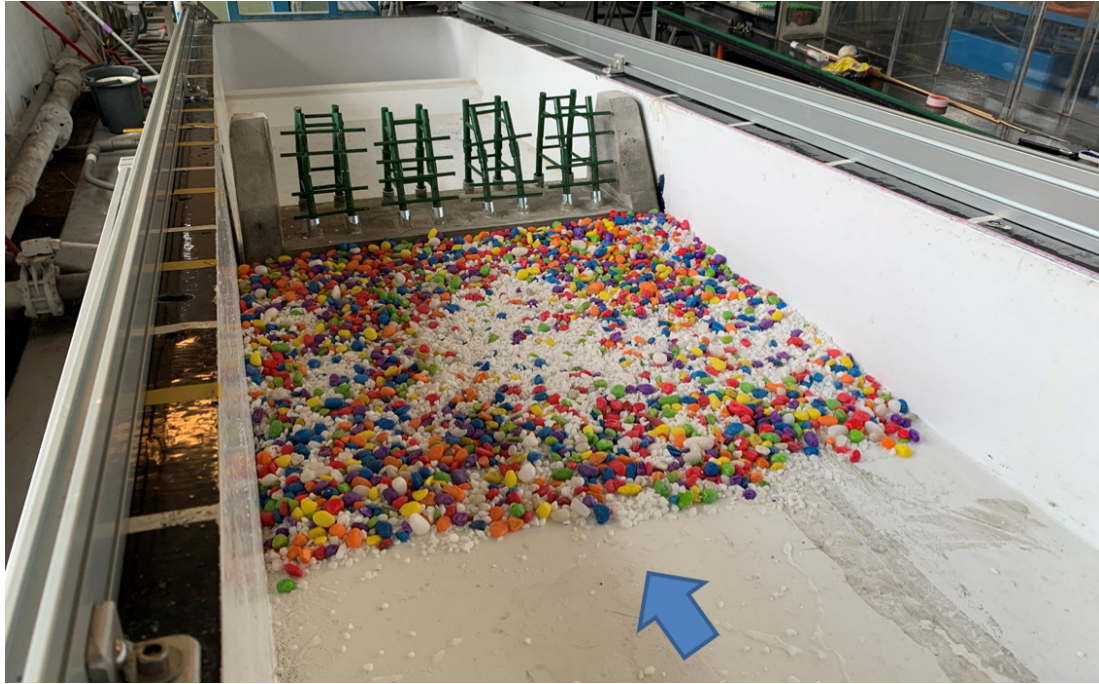
圖 2-10 河工動床教學試驗水槽與防砂壩配置(續)。
