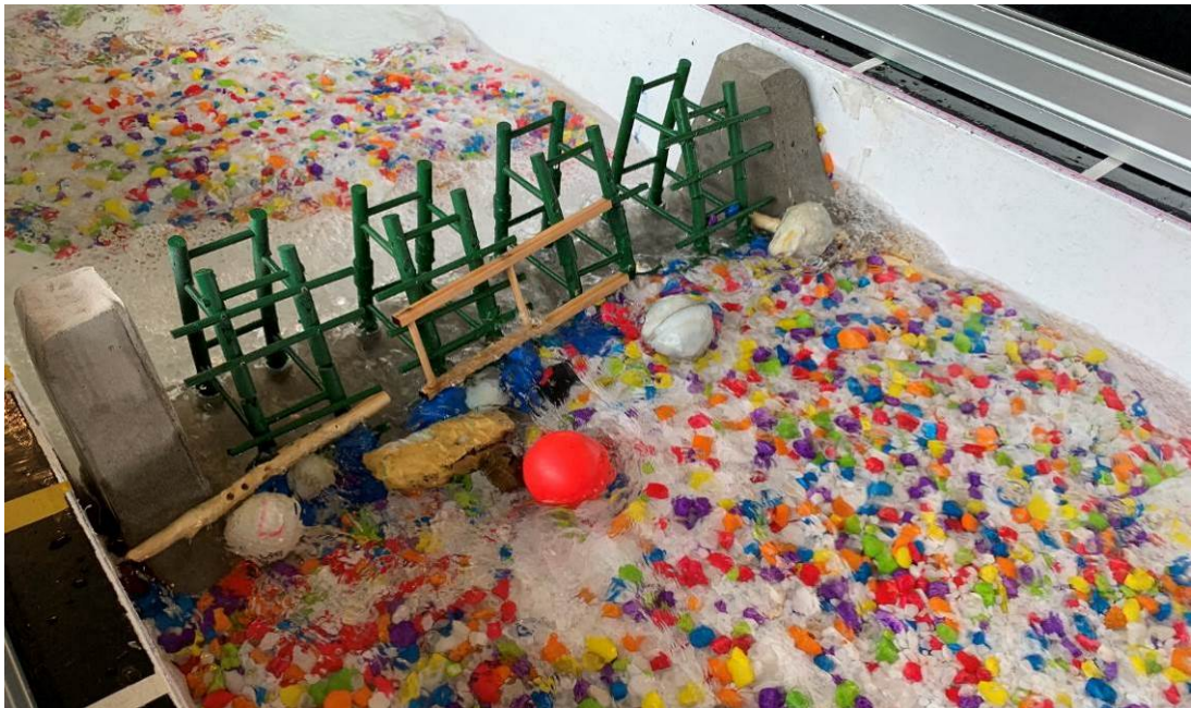
圖 2-11 巨型漂流物阻擋水流通過，造成上游淤積之現象。
