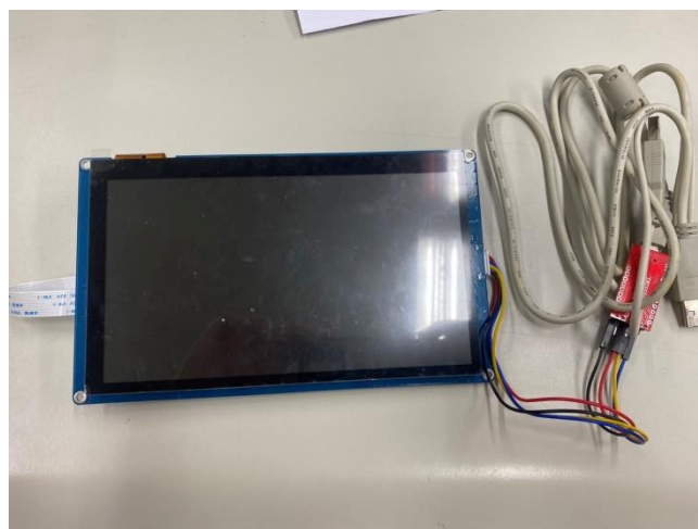
圖 3-4 人機介面正面照(攝於 111 年 05 月 20 日)
