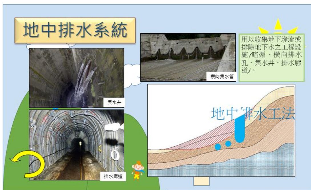
圖 3-29 地中排水工法介紹 (人機介面)
