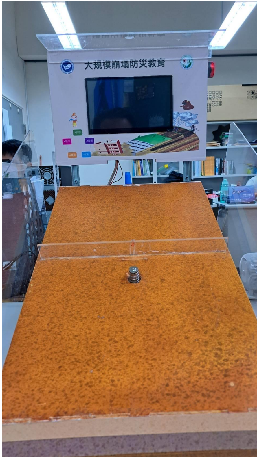
圖 3-2 順向坡基底模組組立完畢樣貌(攝於 111 年 06 月 10 日)
