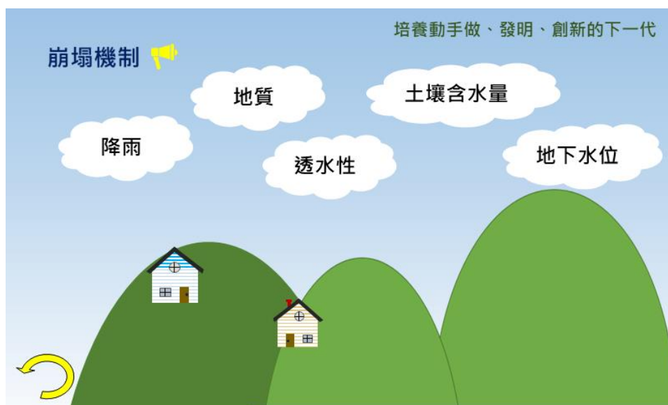
圖 3-42 崩塌發生機制
