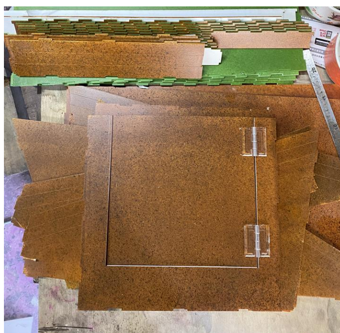
圖 3-1 順向坡基底模組雷射切割零件(攝於 111 年 06 月 10 日)
