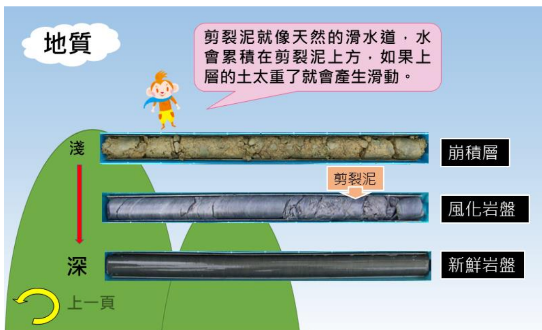
圖 3-44 崩塌發生機制(發生因子：地質)
