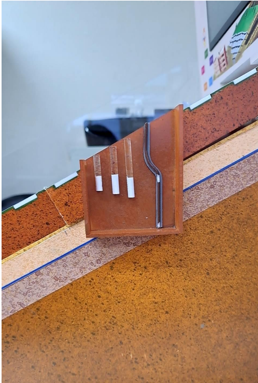
圖 3-16 地下水位觀測井及傾斜管
