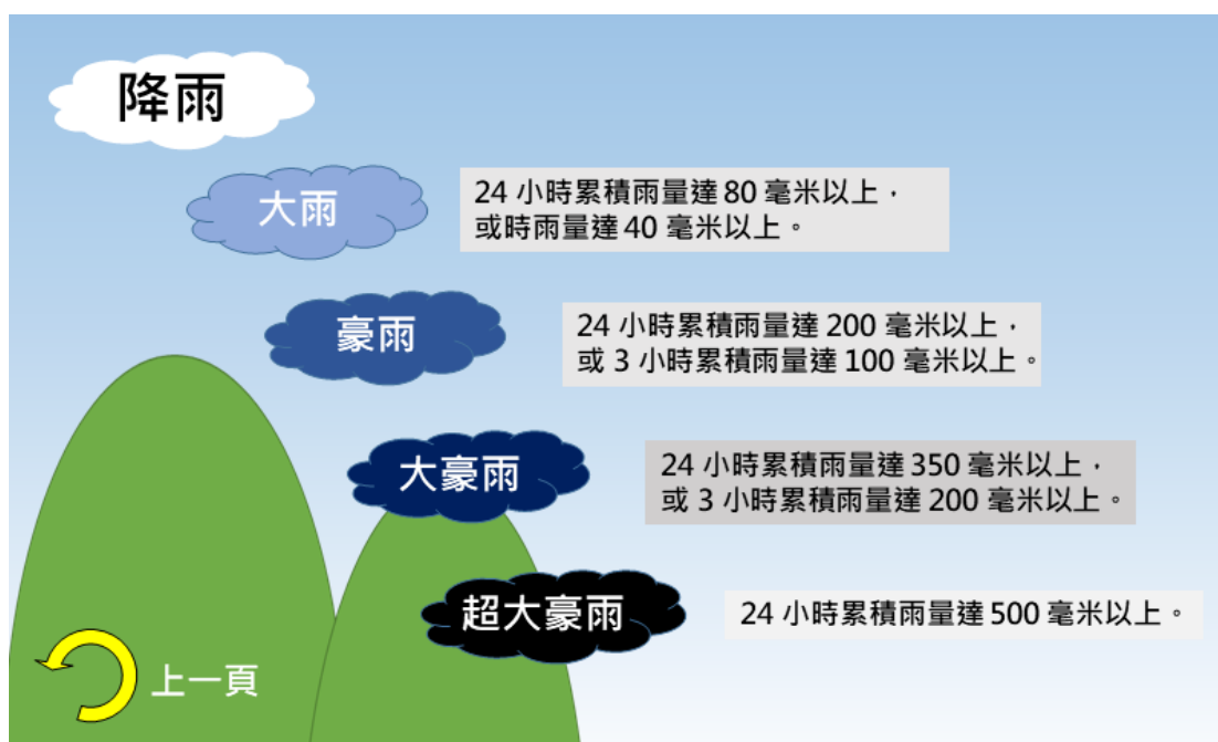
圖 3-43 崩塌發生機制(發生因子：降雨)
