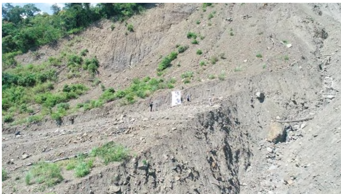
圖 6-11 UAV 距離標尺 50m 之標尺(UAV 視角)
