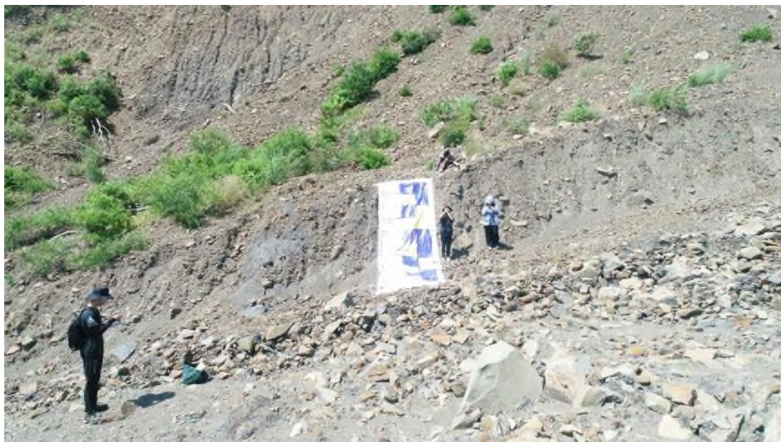
圖 6-10 UAV 距離標尺 16m 之標尺(UAV 視角)
