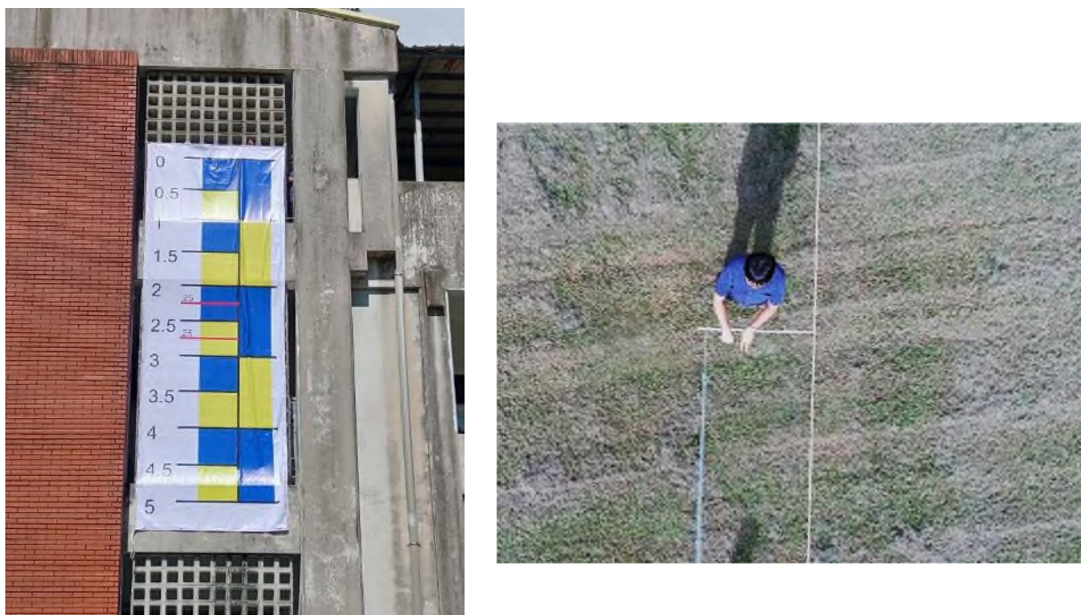
圖 6-2 屏科大水保系館之 UAV 影像長度率定之大型標尺布幕及地面 距離控制標尺及距離標示(UAV 視角)
