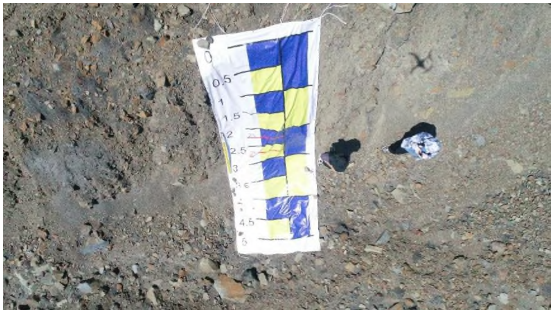
圖 6-9 寶來大規模崩塌地 UAV 影像長度律定之大型標尺布幕，標尺正上方，距離標尺 0m (UAV 視角垂直拍攝)
