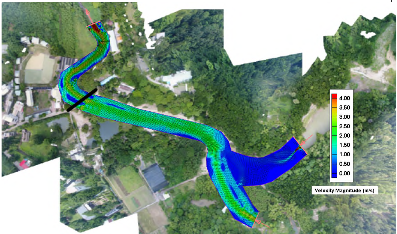
圖 4- 8 河道現況(工程前)之流速分布 (黑線為虎源橋)
