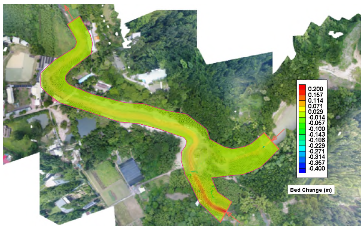
圖 4- 15 考量河道加寬方案之動床輸砂模擬結果
