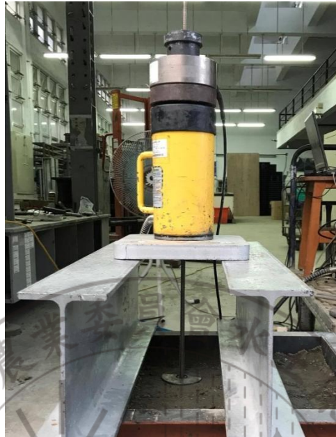
圖 3-7 抗拉試驗儀器架設
