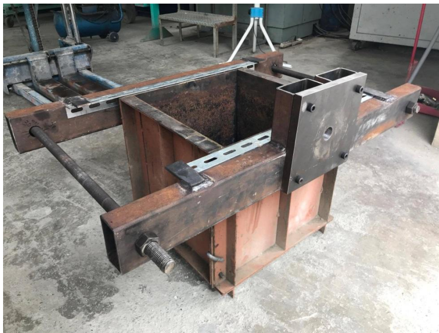
圖 3-8 側向剪力反力架及土樣模具
