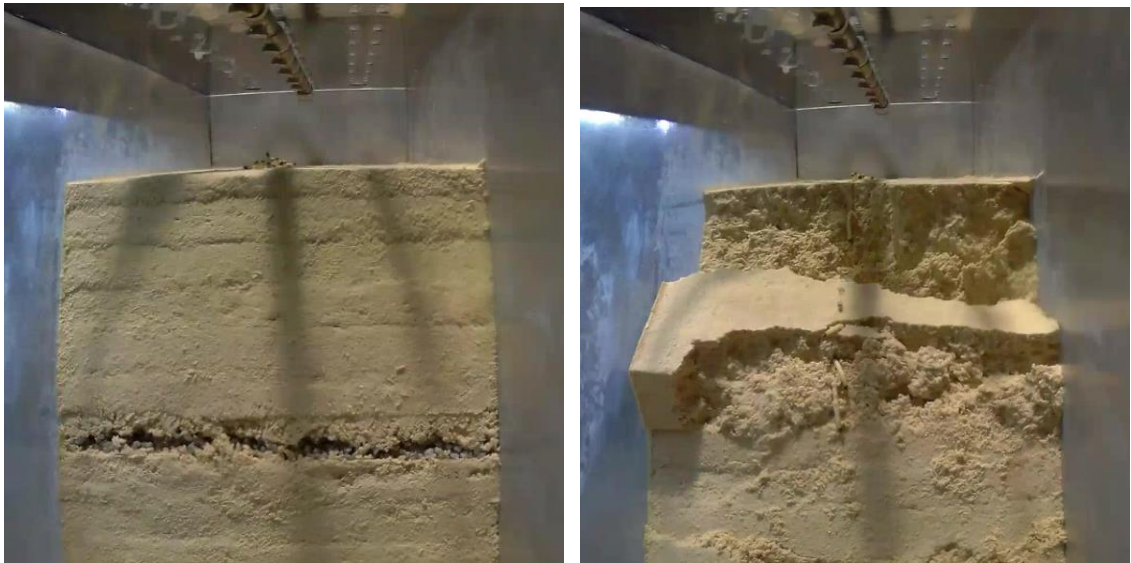
圖 4-42 未降雨前試驗過程 (左) 試驗前 (右) 試驗中(加速度值達 35G)
