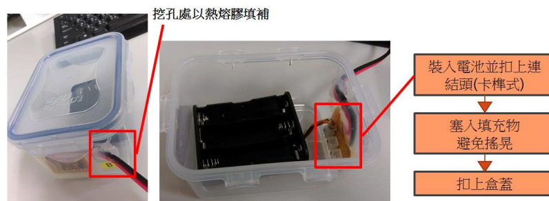
圖 3-30 電力單元結構
