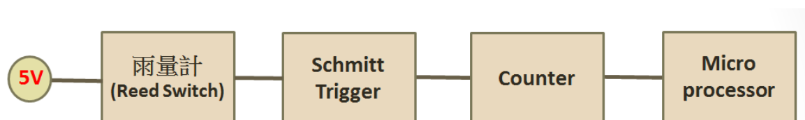
圖 3-23 雨量計訊號處理流路
