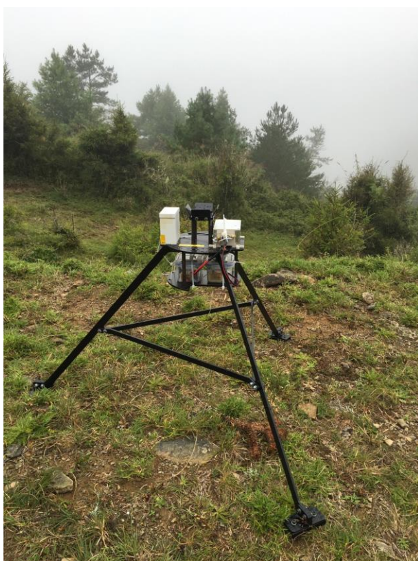
圖 3-45 放置於塔塔加鞍部鹿林山莊附近的雨量計的整體外觀
