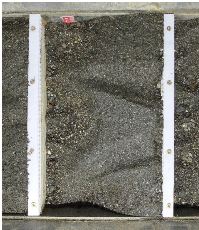
圖 4-8 透水式 B 型系列固床工間渠床砂之發展
