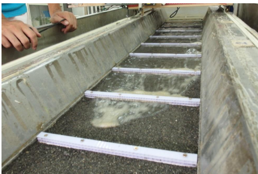
圖 4-7 水流穿越透水式 B 型固床工透水格柵的情形
