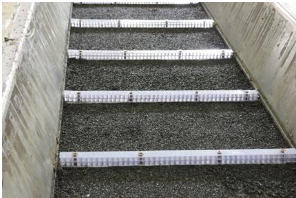
圖 3-3 系列透水式 B 型固床工模型
