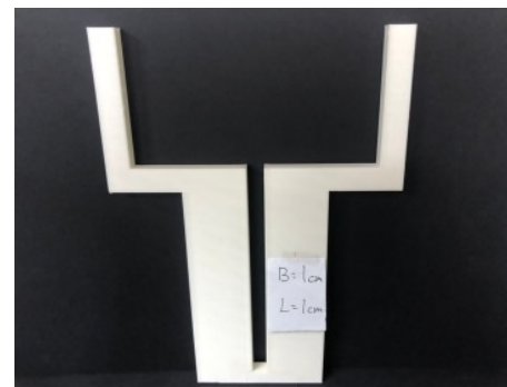
滯洪壩與矩形緊急溢洪口共構下之流量試驗
