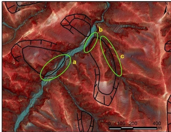
圖3.2.6地滑地形Polygon的修正例3（岩塊邊界）
