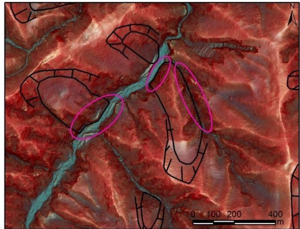
圖3.2.6地滑地形Polygon的修正例3（岩塊邊界）
