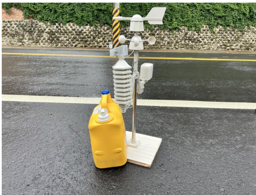
圖 5-35 測試 Arduino 開放硬體自動氣象站現場情況
