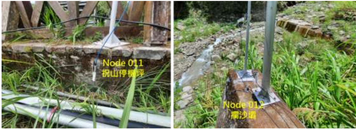
圖 4-17 Node 011 與 Node 012 傾斜儀裝設位置圖
