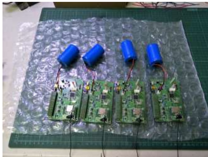
圖 4-2 LoRa 發射站實際設備內部配置
