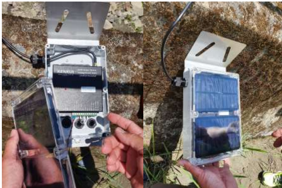
圖 2-21 搭配太陽能模組之 LoRa Node
