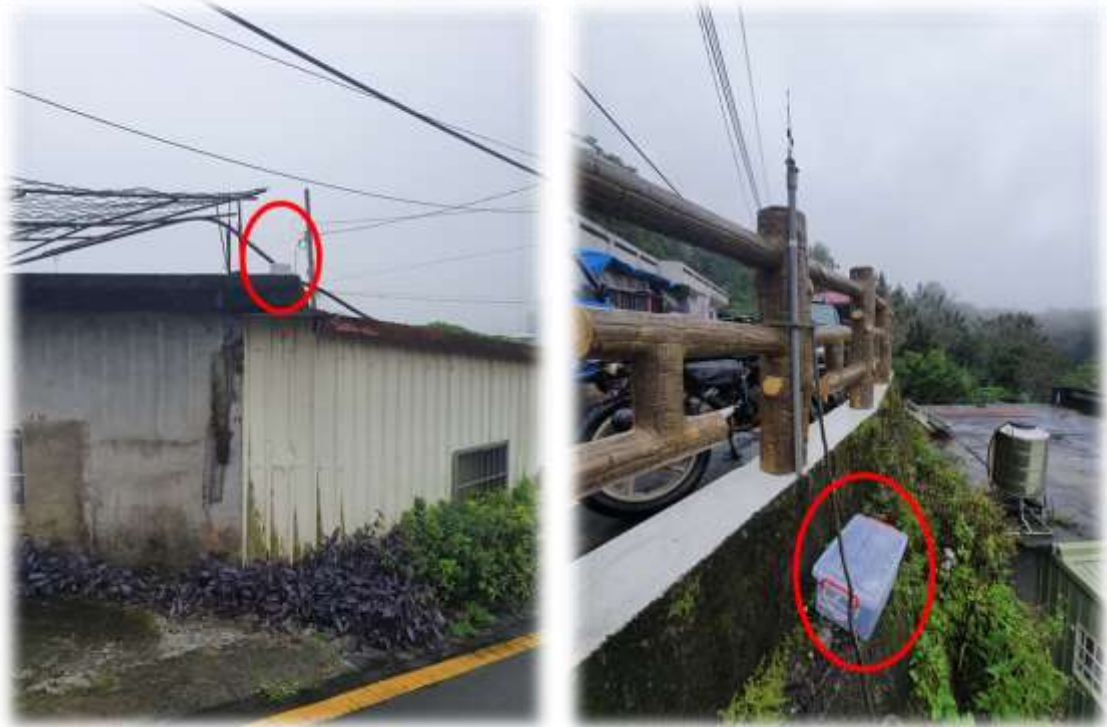
圖 4-33 利用簡易測站模組於現地進行傳輸測試
