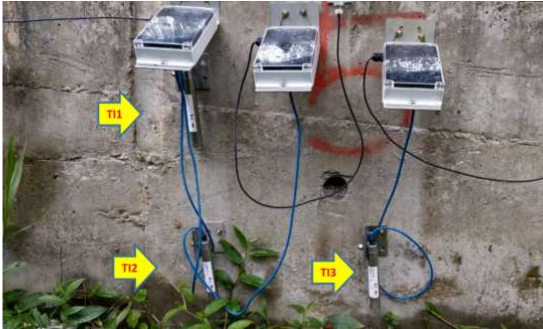
圖 4-27 光華崩塌地傾斜儀現場配置圖
