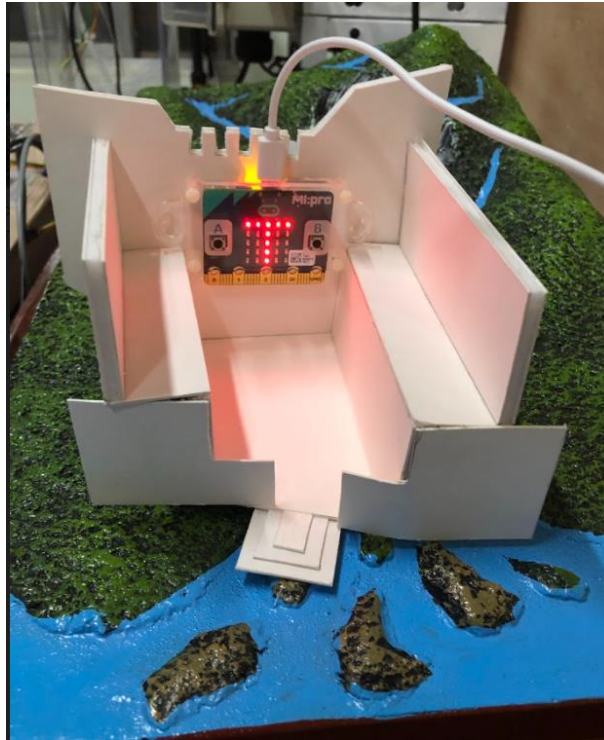
圖2-42 防砂壩傾斜之感測器設備配置
