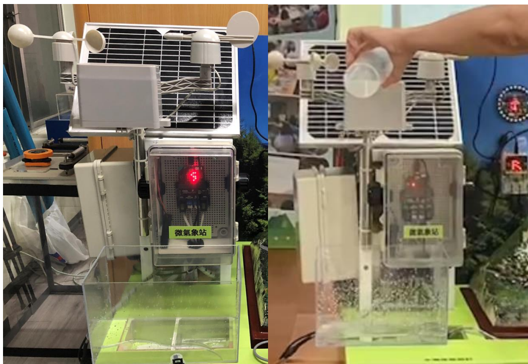
圖 2-21 微氣象站之雨量偵測與雨量計讀數測試
