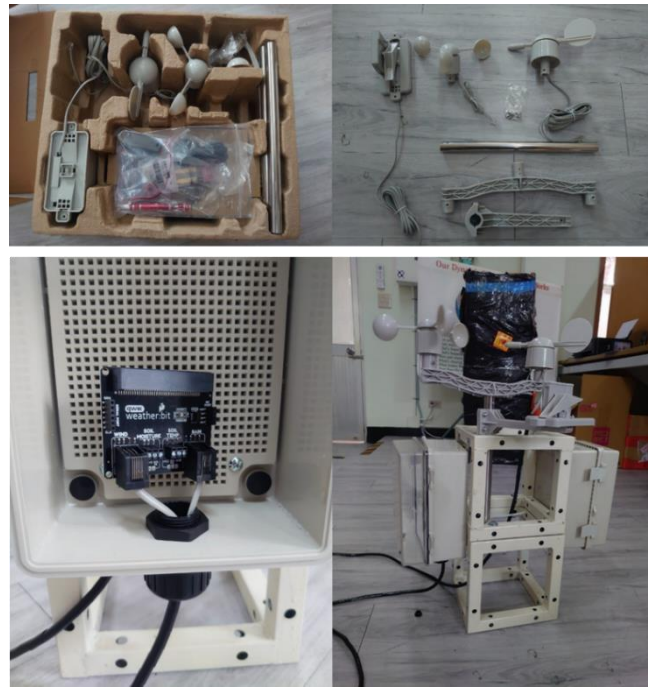
圖 2-30 micro:bit 微氣象站之組裝
