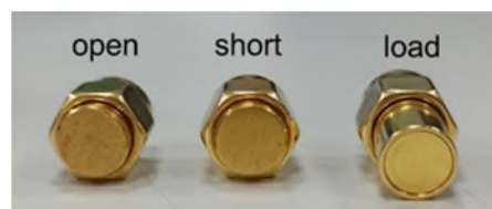
圖 2-94 SMA 校正元件 (開路 open, 短路 short, 負載 load)
