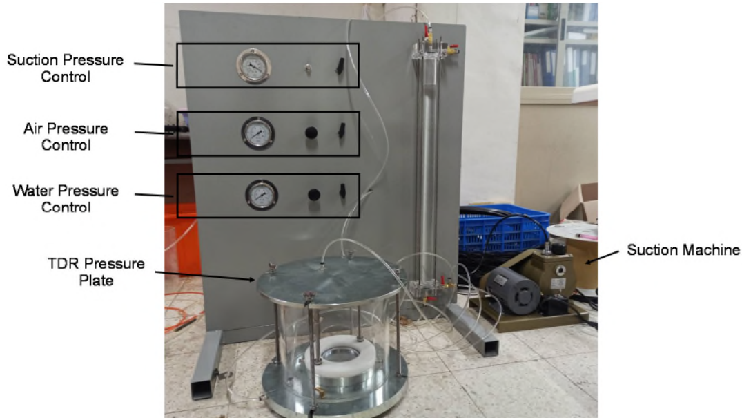
圖 2-30 本研究 TDR 壓力鍋實體照片
