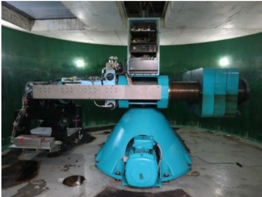
圖 2-124 中央大學土木系之地工離心機
