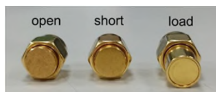
圖 2-89 SMA 校正元件 (開路 open, 短路 short, 負載 load)
