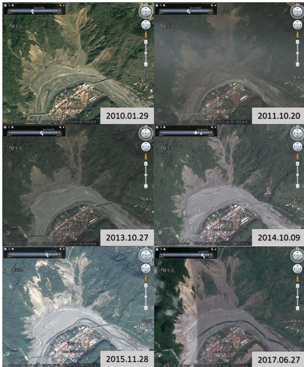
圖 3-4 荖濃溪右岸邊坡 2010 年～2017 年變遷圖(Google Earth 影像)
