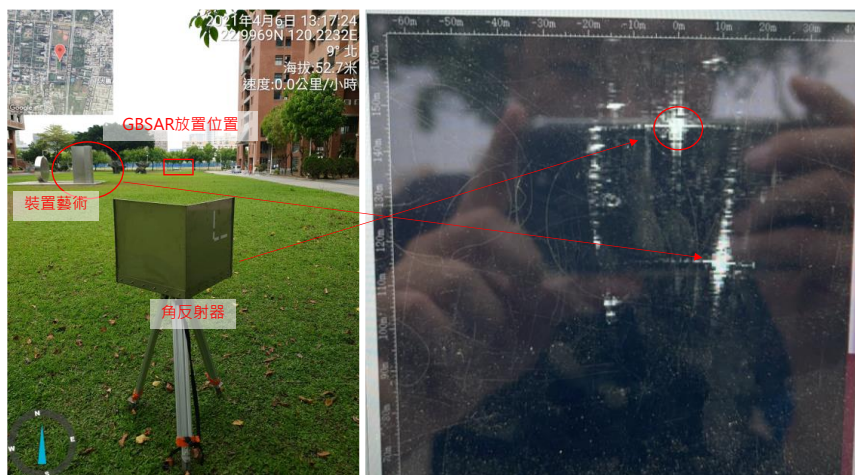
圖 5-12 強反射點位移測試角反射器與雷達回波圖
