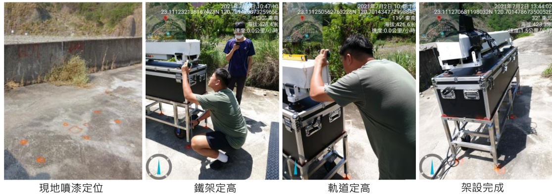
圖 5-19 巡迴式監測儀器架設方式
