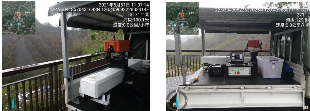
圖 4-47 車載 GB-SAR 觀測現地照片(臺南牛埔)
