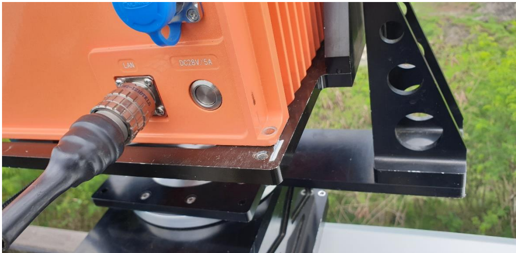
圖 5-22 雷達主機(含天線)於俯仰平台位移
