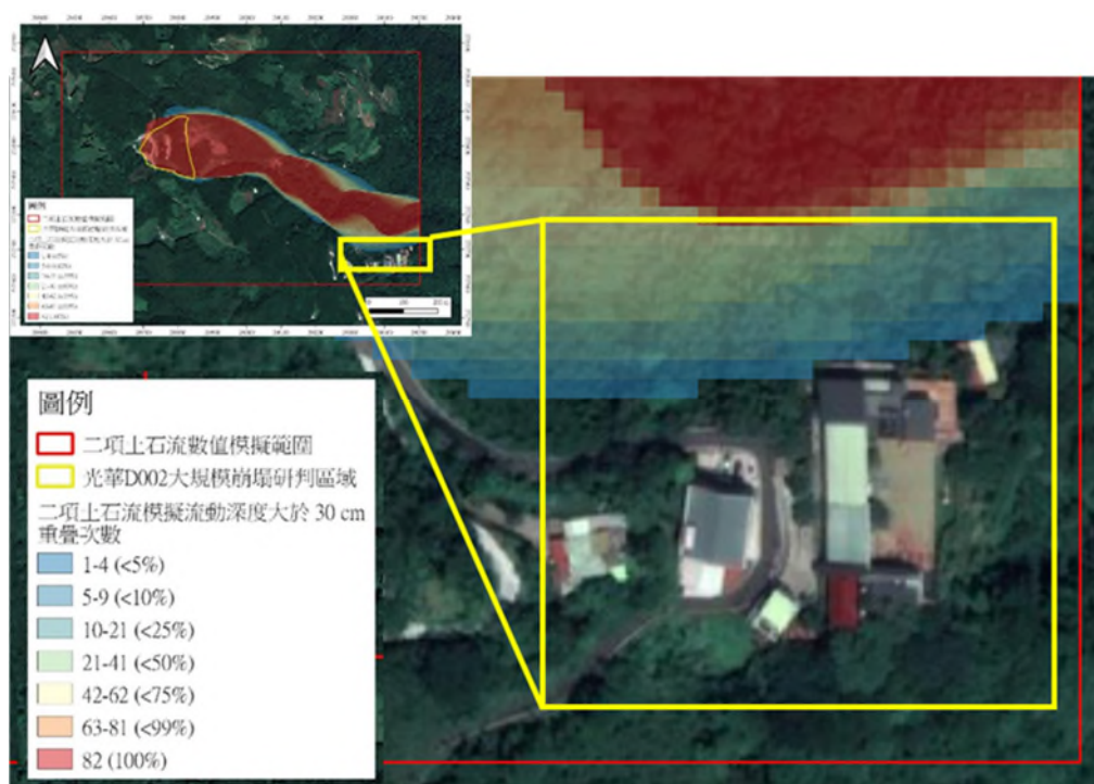
圖 6.4 光華 T002 情境二 82 組隨機參數之土砂流流動深度大於 30 公分之路徑重疊局部放大圖
