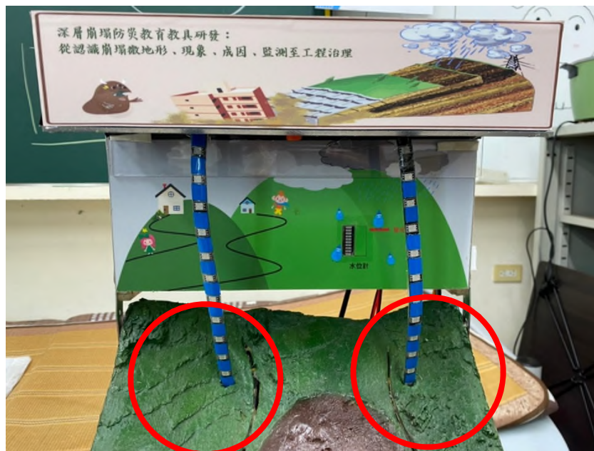
圖 9 降雨模擬器之 LED 燈條安裝於坡體中，圖中紅色圓圈為坡體上孔洞對應之 LED 燈條
