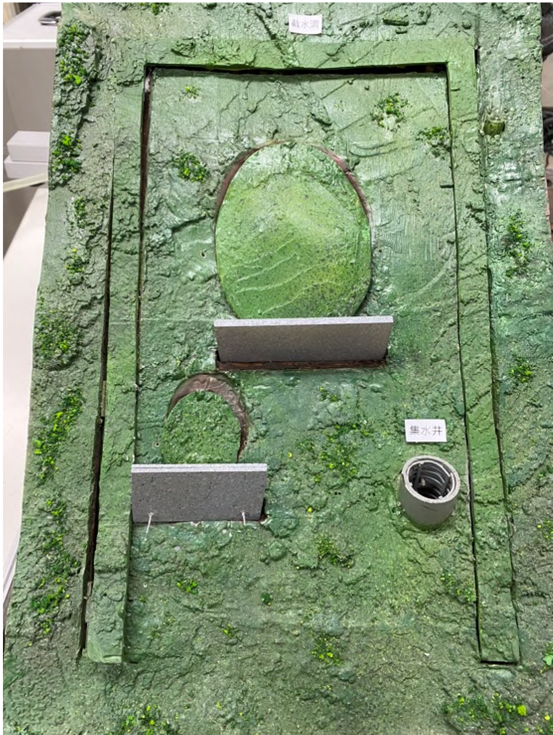
圖 3.30 坡腳開挖後裝設擋土牆於深、淺層崩塌區 (攝於 110/10/20)
