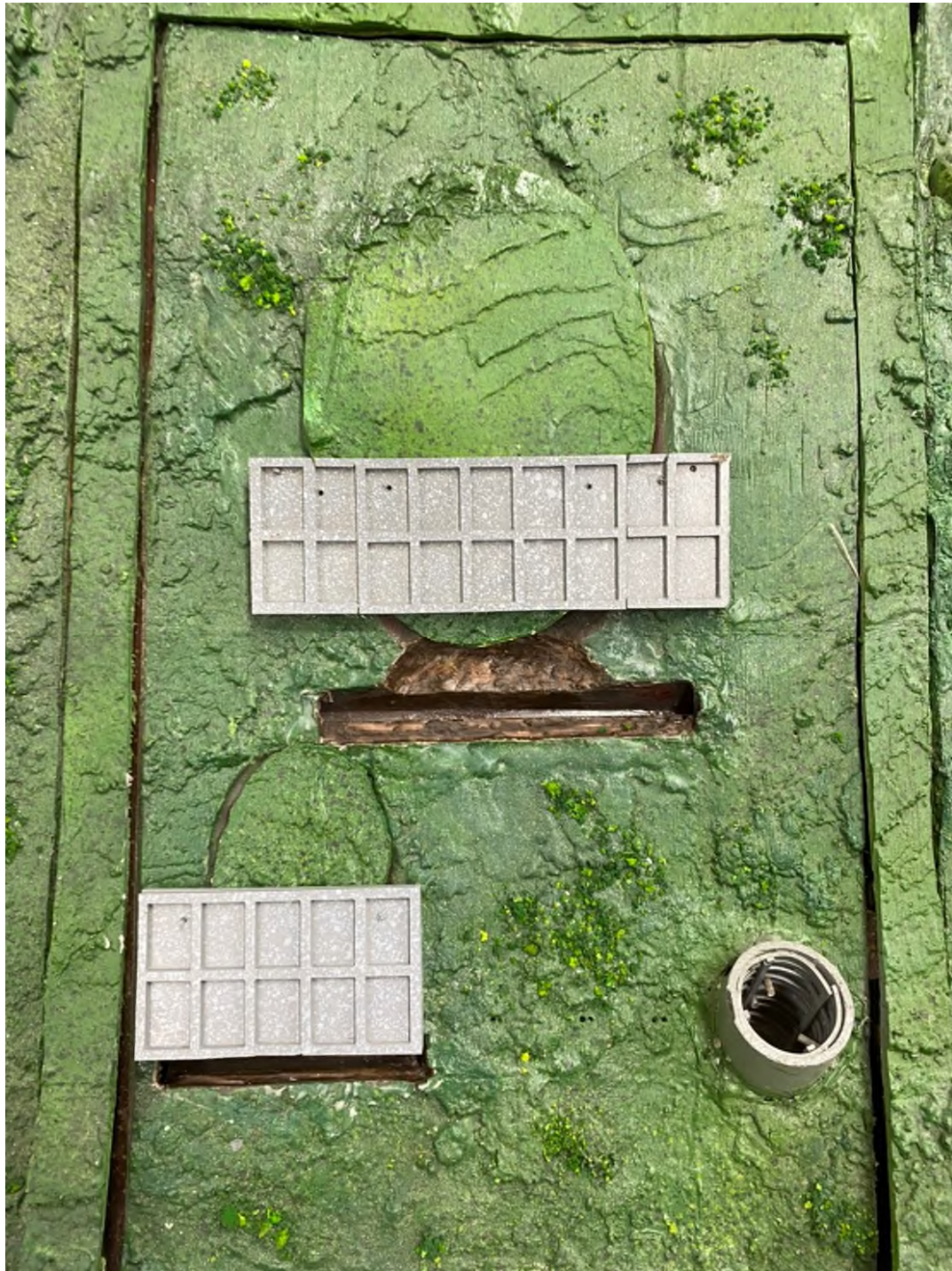
圖 20 格樑護坡工法安裝位置
