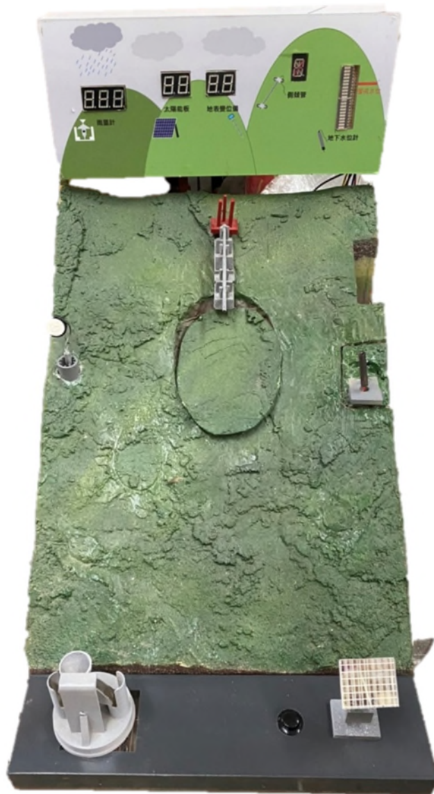
圖 3.17 崩塌地監測系統模組正面照片(攝於 110/10/20)
