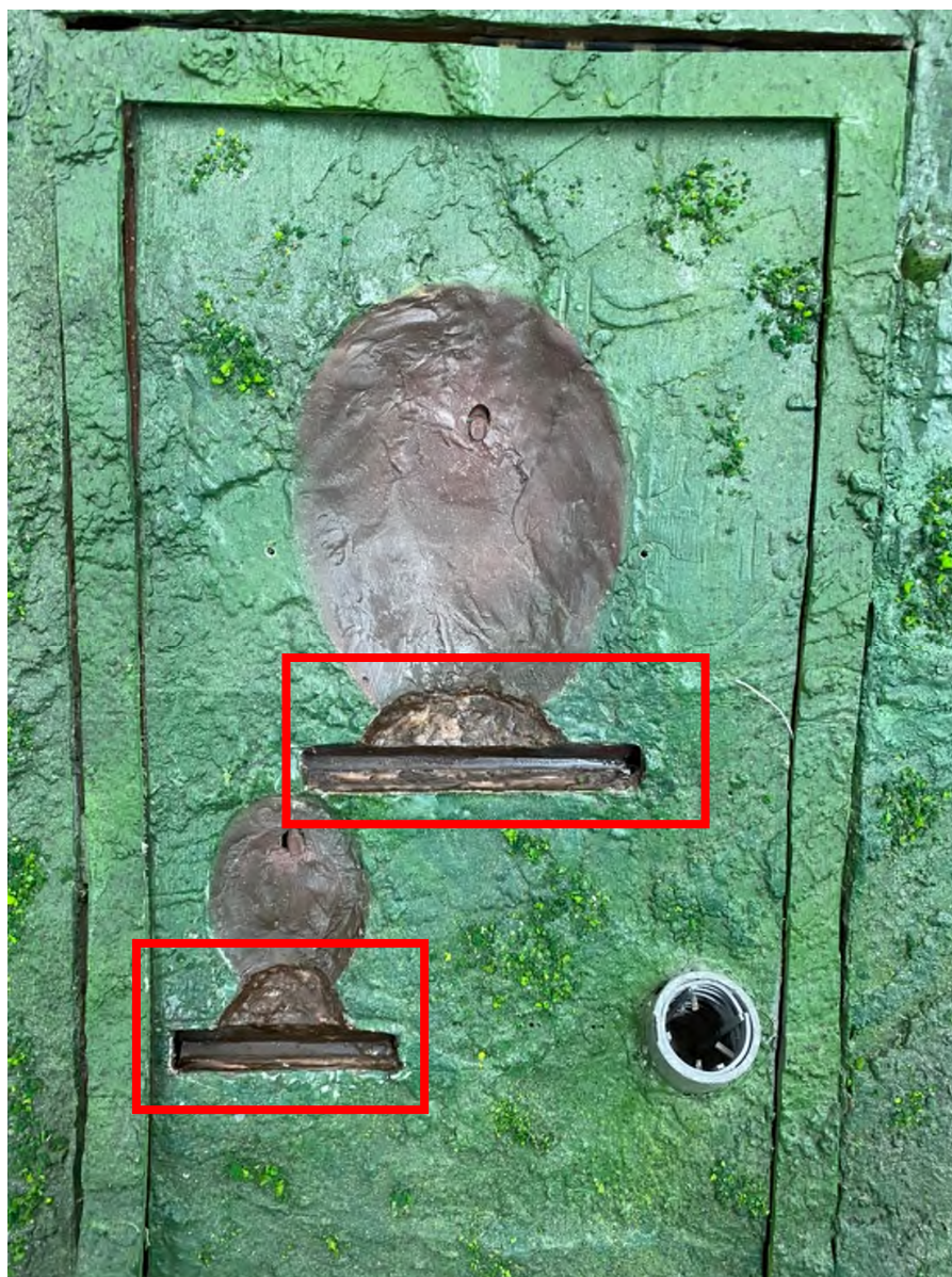
圖 43 深、淺層崩塌之坡趾開挖位置(上方紅色方框為深層崩塌坡趾位置；下方紅色方框為淺層崩塌坡趾位置)
