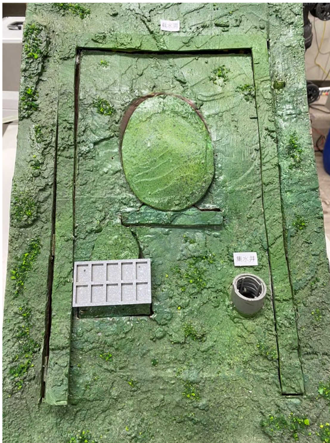
圖 3.33 格樑護坡裝設於淺層崩塌區 (攝於 110/10/20)
