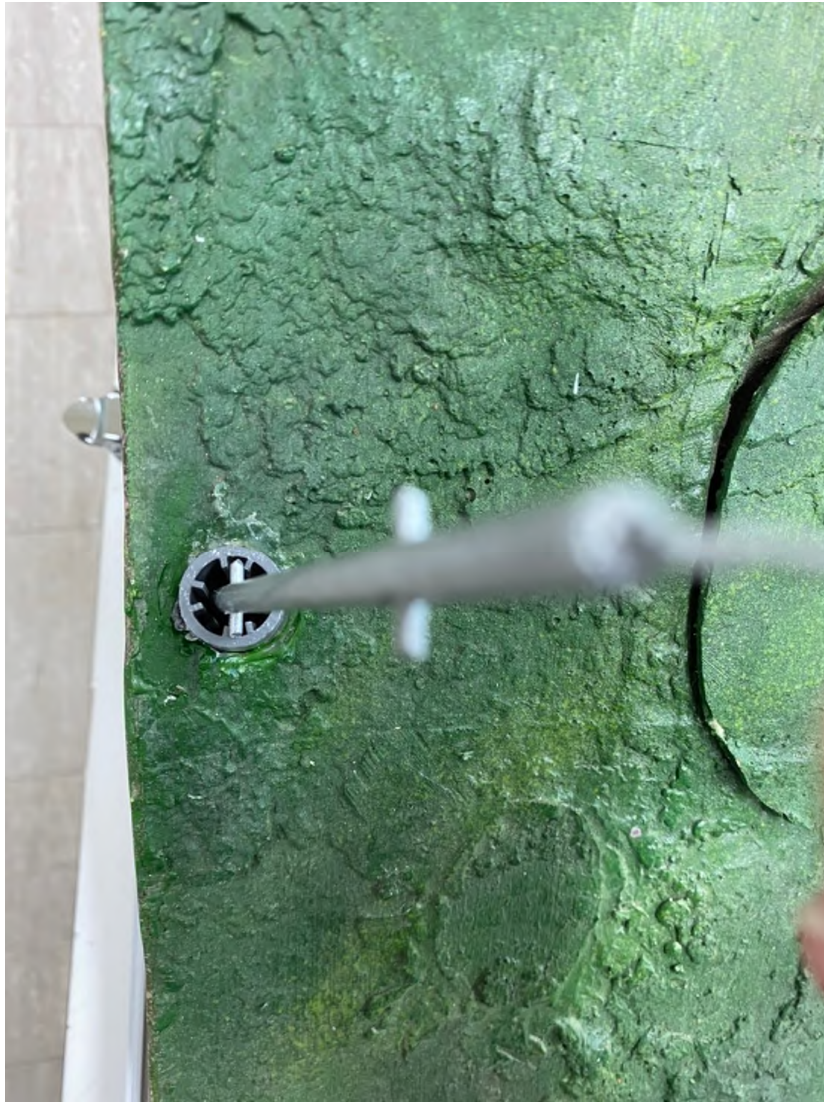
圖 3.20 傾斜管測量設備與十字滑軌模型 (攝於 110/10/20)
