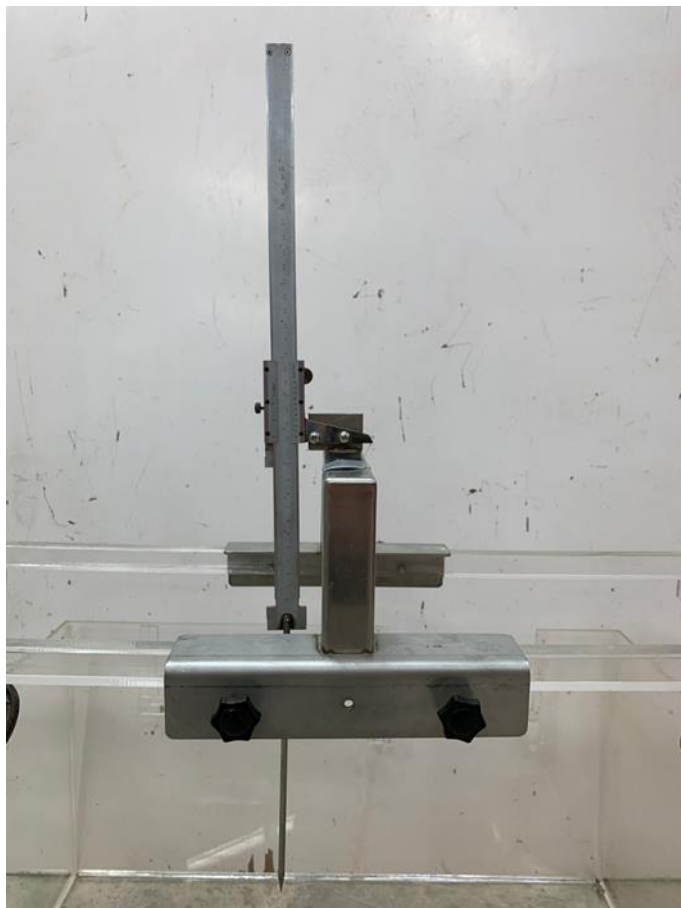
圖 5-6 探針式水位量測裝置
