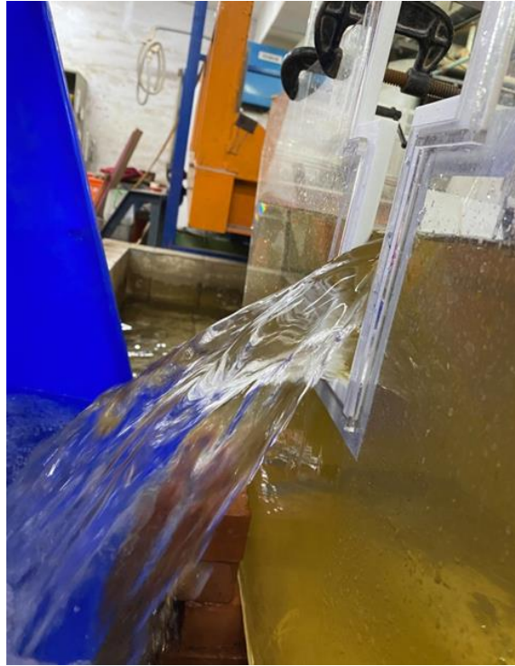
圖 6-12 懸臂式滯洪壩過壩水流水舌下彎
