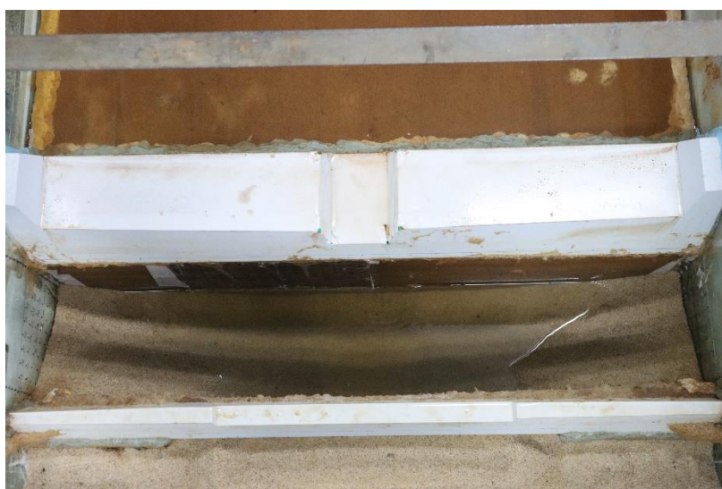
圖 3-19 沖刷坑積水情況圖
