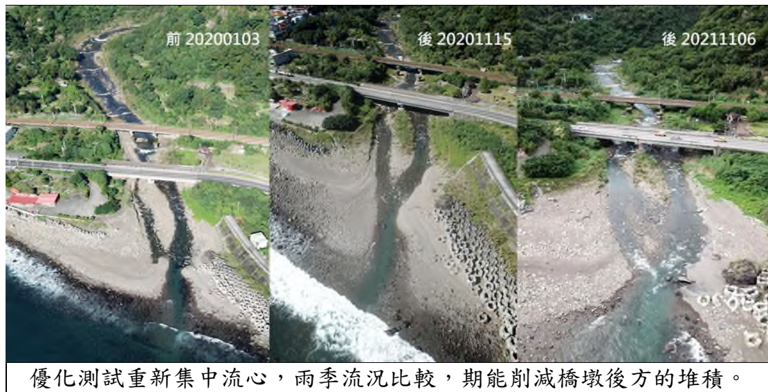
圖 4.4 固床工#1 優化測試前後，主要的棲地型態改變
