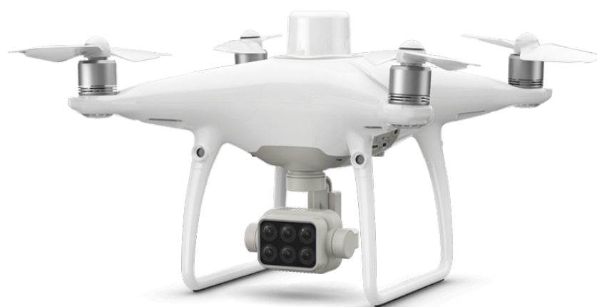
圖 2-3 DJI 光譜無人機 P4 Multispectral
