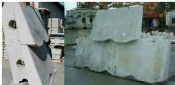
圖 2.28 無人化施工對應自立式模板混凝土塊
