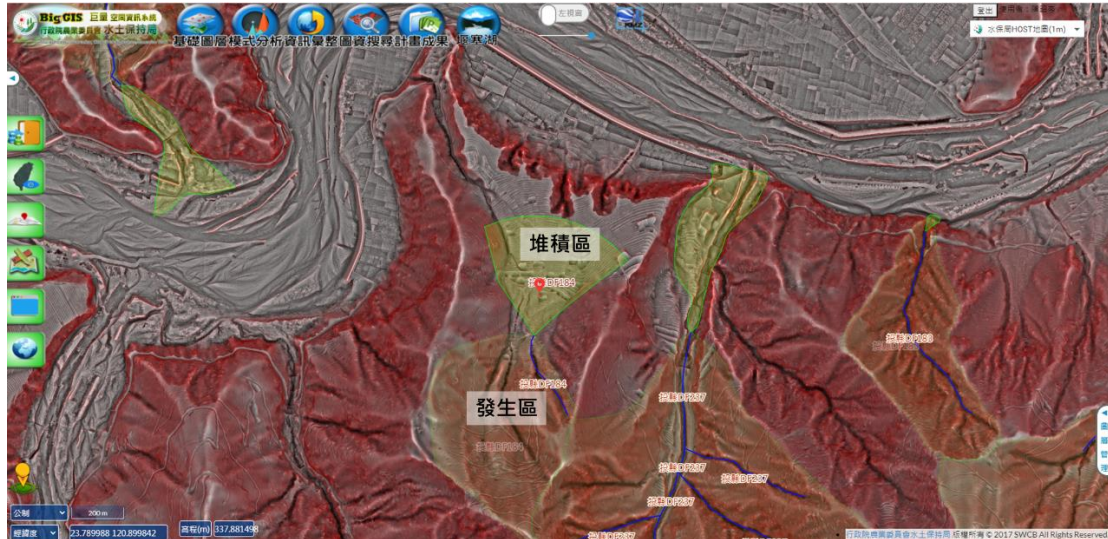
圖 5- 33、坡面型土石流。(土石流潛勢溪流-投縣 DF184，坐標 23.782134 120.917566)
