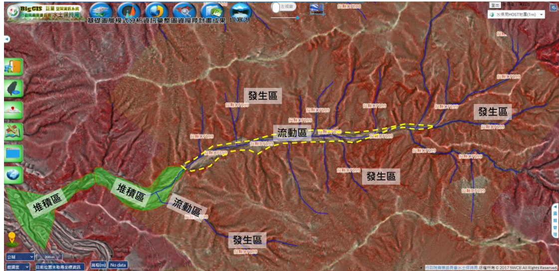
圖 5- 32、溪流型土石流。(土石流潛勢溪流-投縣 DF199，坐標 23.526907 120.858750)
