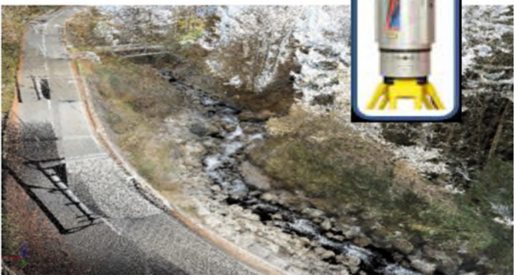
地上雷射計測所得點雲
