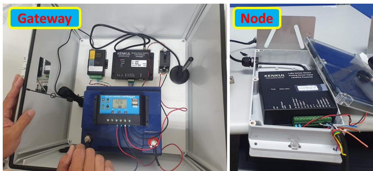
圖 3-30 本團隊使用之太陽能儀器箱內部配置圖
