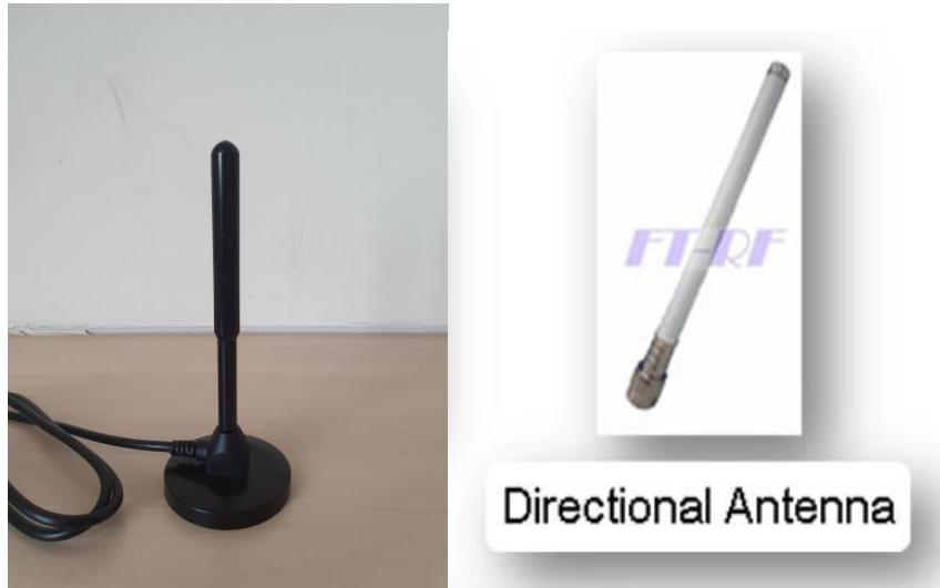
圖 3-7 本研究使用 LoRa 傳輸天線，左為 35dbi、700-2700MHz 全頻段天線， 右為 5dbi、915MHz 天線
