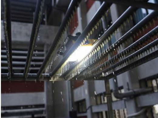
圖 2-28 檢查降雨機針頭穩定
